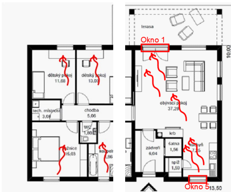
Obrázek 44: Možnosti příčného provětrání modelové budovy
