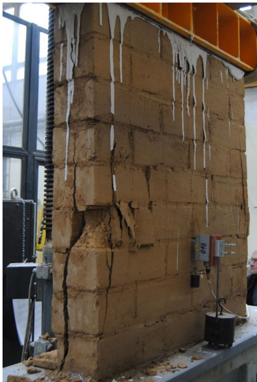
Obrázek 87 - Porušení pilíře III při zátěžové zkoušce, foto: Petr Čanda
