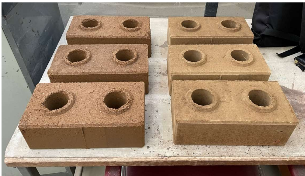
Obrázek 81 - Porovnání cihel bez stabilizace a s cementovou stabilizací, foto: autor
