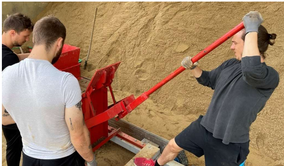
Obrázek 53 - Lisování cihel, foto: autor
