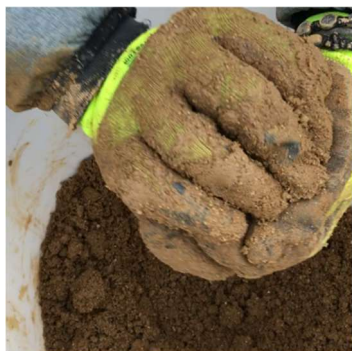
Obrázek 737 - Ball test (1), foto: autor
