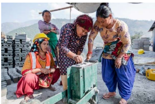
Obrázek 29 - Lisování hliněných cihel, zdroj: www.impactnepal.org
