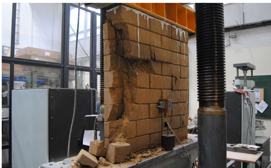
Obrázek 85 - Porušení pilíře I při zatěžovací zkoušce, foto: Petr Čanda
