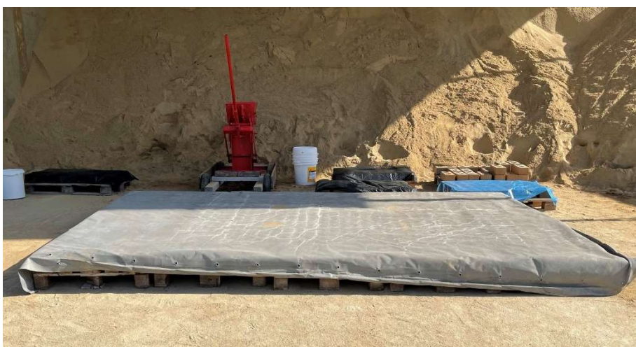
Obrázek 56 - Přikryté čerstvě vylisované cihly, foto: autor
