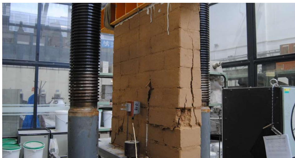
Obrázek 86 - Porušení pilíře II při zátěžové zkoušce, foto: Petr Čanda
