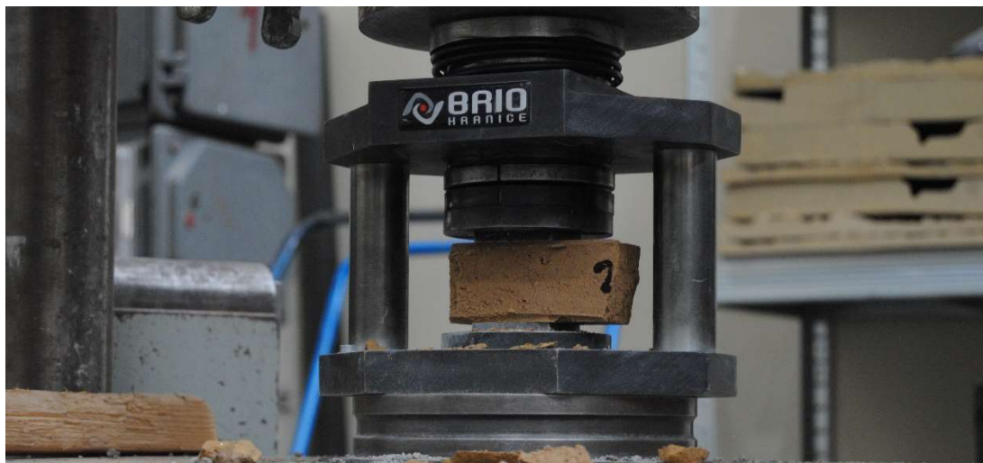
Obrázek 79 - Zkouška v tlaku na zlomcích. foto: Petr Čanda
