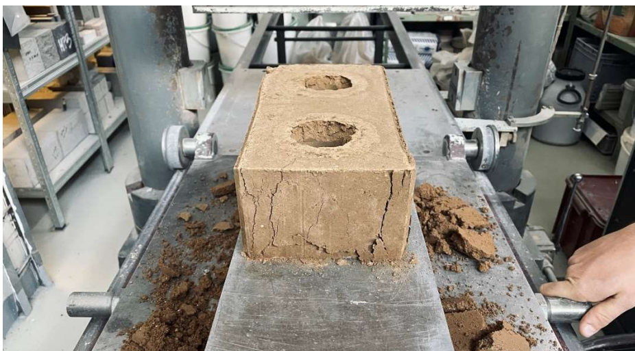
Obrázek 83 - Porušení cihly bez povrchových úprav, foto: autor
