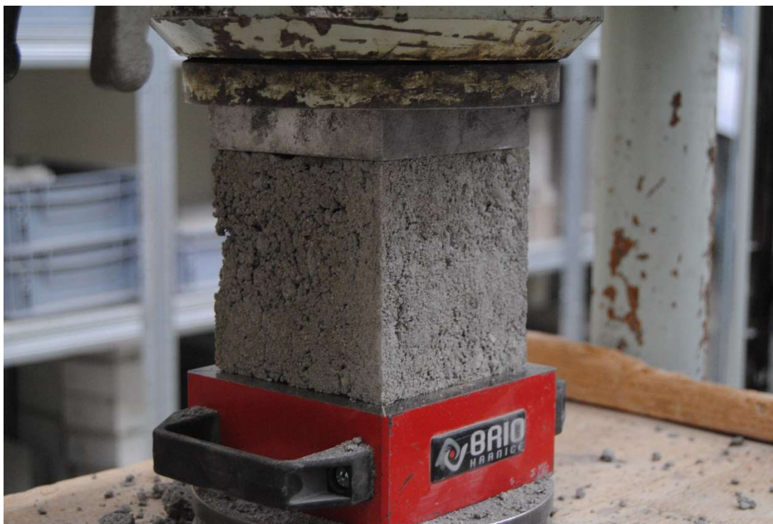
Obrázek 80 - Zkouška pevnosti v tlaku výplňového betonu, foto: Petr Čanda
