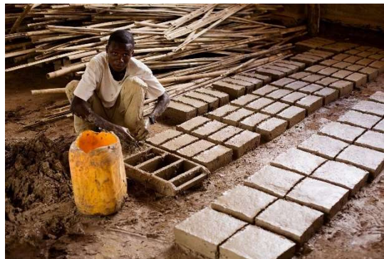
Obrázek 264 - Výroba nepálených hliněných cihel, zdroj: https://www.zrs.berlin/
