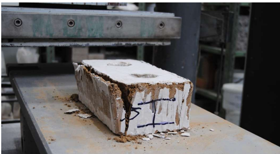
Obrázek 84 - Způsob porušení cihel s povrchovou úpravou, foto: Petr Čanda
