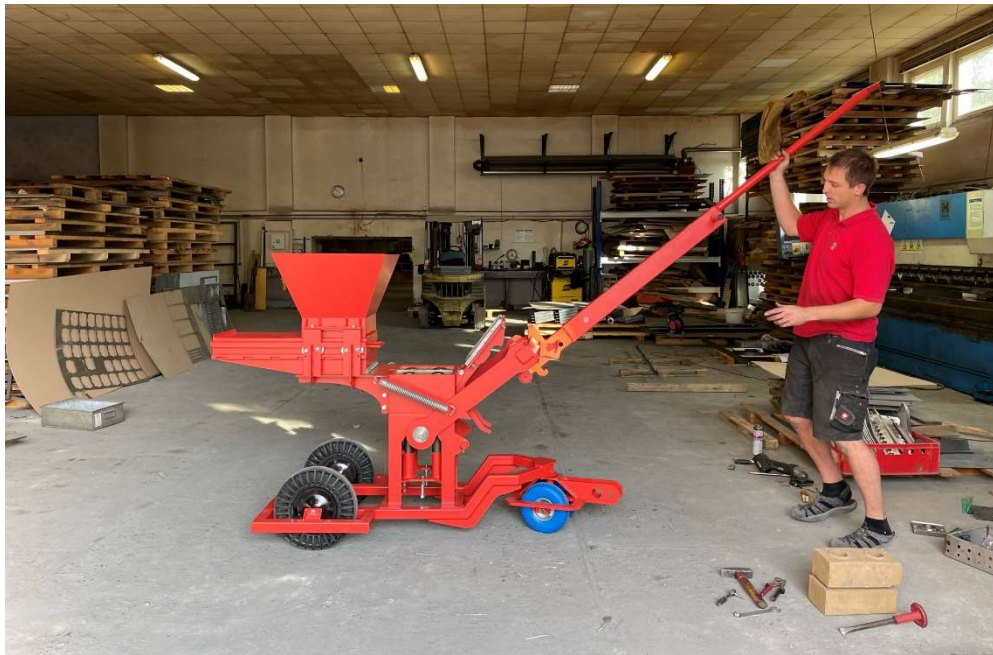
Obrázek 50 - Sestavený prototyp vylepšeného manuálního lisu, foto: autor
