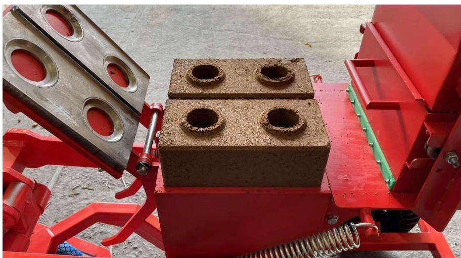
Obrázek 54 - Čerstvě vylisované cihly, foto: autor
