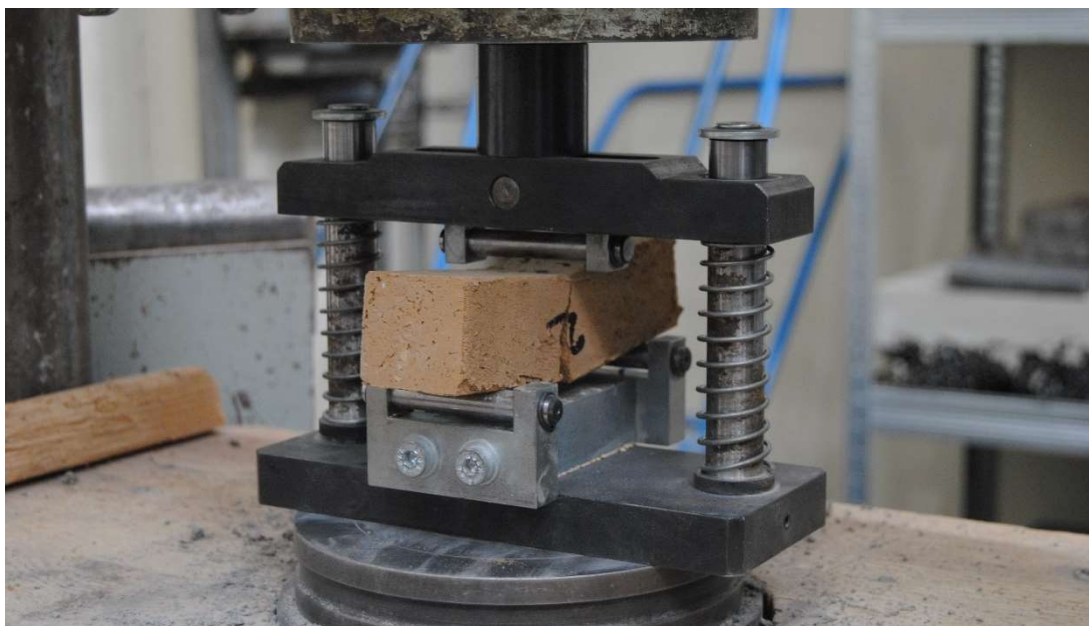
Obrázek 78 - Zkouška pevnosti v ohybu, foto: Petr Čanda
