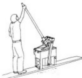
Obrázek 46 - Jednoduchý manuální lis na výrobu hliněných cihel, zdroj [15]
