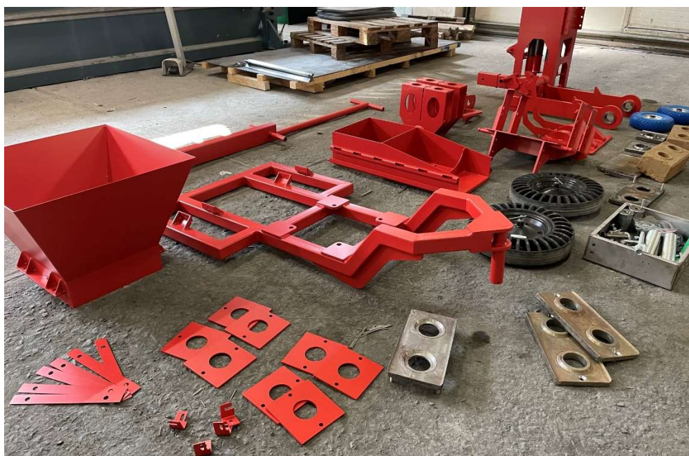
Obrázek 48 - Jednotlivé díly vylepšeného prototypu manuálního lisu, foto: autor
