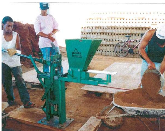
Obrázek 17 - Příprava hliněné směsi, zdroj: https://www.jarfel.com.br/
