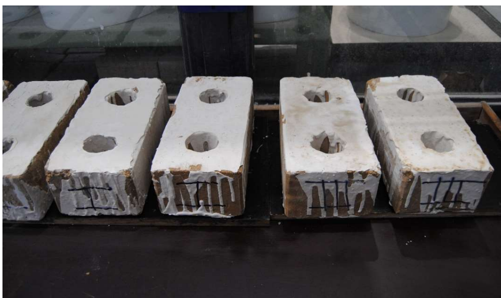
Obrázek 82 - Zaříznuté a zasádrované vzorky cihel před stlačením, foto: Petr Čanda
