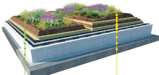
Obrázok 7: Polointenzívna zelená strecha ISOVER – strešná lúka
