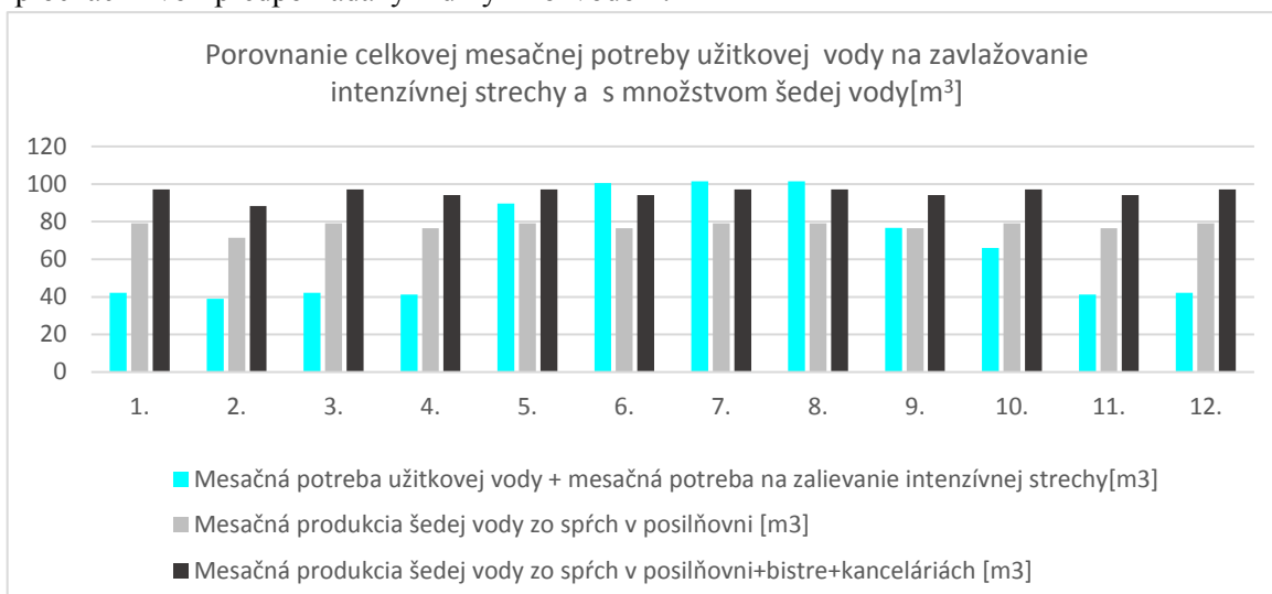
Graf 4: Porovnanie mesačnej potreby vody na zavlažovanie a splachovanie s množstvom šedých vôd z objektu.
