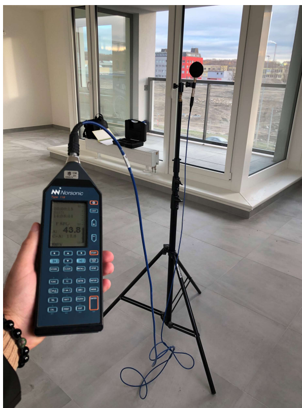
Obrázek 7.7: Zachycený průběh měření vč. ukázky mikrofону a zvukoměru [foto pořízeno autorem]
