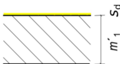
Obrázek 3.13: Skladba povlakové podlahy [11]
