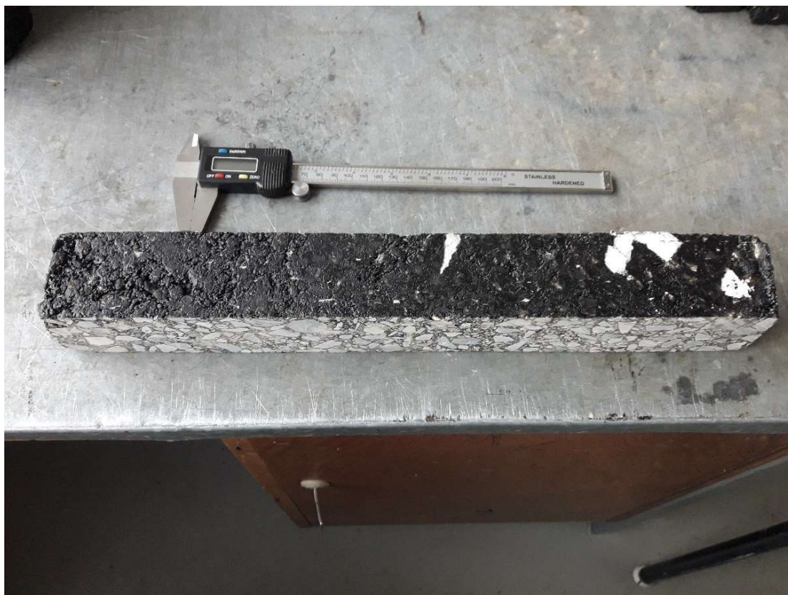
Obr. 6 – Zkušební trámek pro čtyřbodovou zkoušku dle ČSN EN 12697-26
