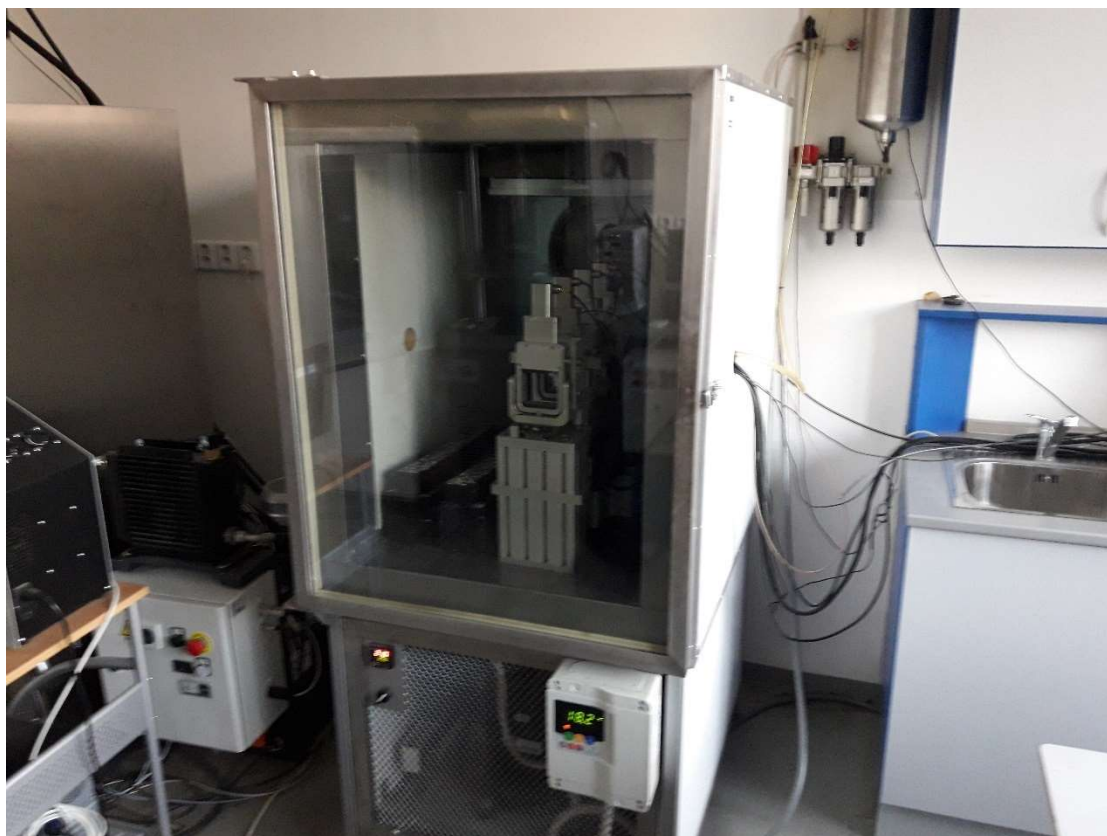
Obr. 9 – Klimatizační komora se zařízením pro zkoušku čtyřbodovým ohybem
