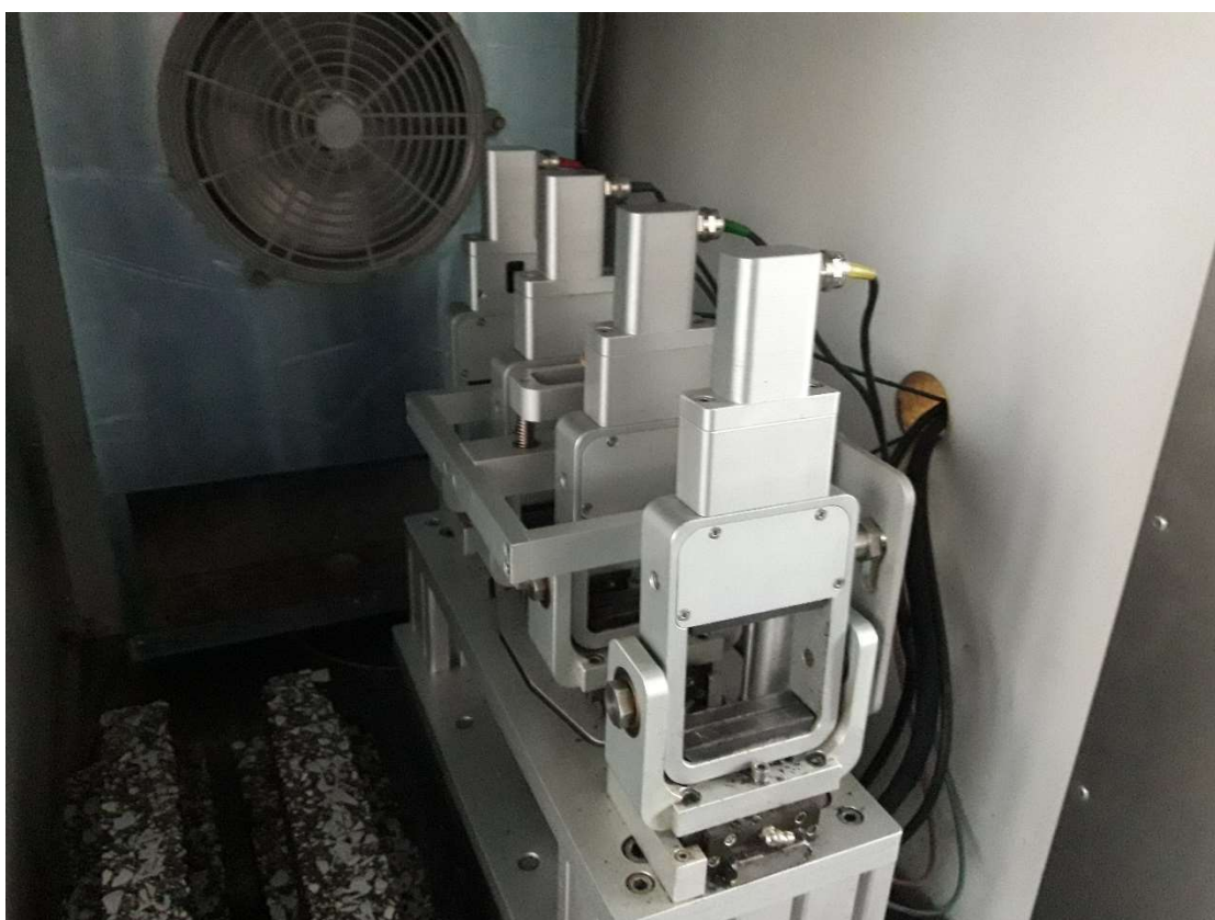
Obr. 10 – Zařízení pro zkoušku čtyřbodovým ohybem
