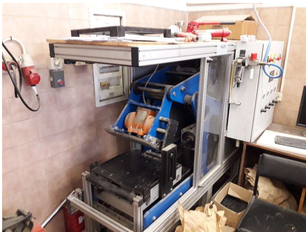
Obr. 5 – Segmentový zhutňovač pro výrobu zkušebních desek
