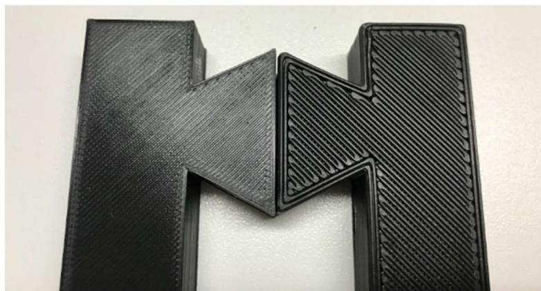
Obrázek 10 Porovnání kvality výtisku s tryskou 0,4 mm (vlevo) a 1,0 mm (vpravo).
