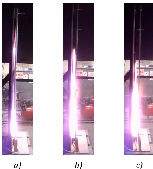
obr. 68: Vizuální zhodnocení průměrné dosahované výšky plamene z průběhu zkoušek pořízených z boku kamerou v dutině: a) šířky 30 mm, b) šířky 50 mm c) šířky 70 mm
