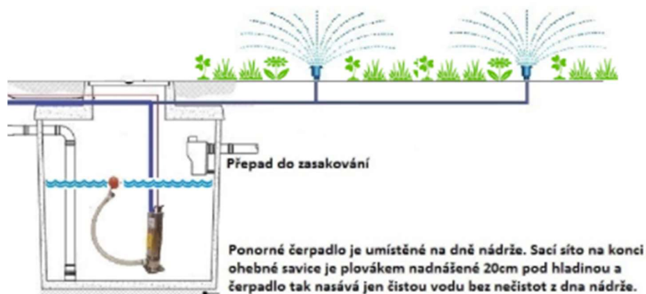
Obrázek 2 Využití dešťové vody v závlahovém systému
