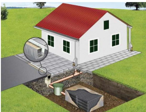
Obrázek 20 Podzemní vsakování dešťové vody pomocí vsakovacích bloků [29]
