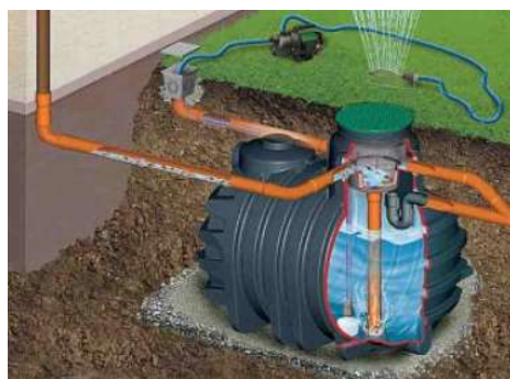
Obrázek 30 Zapojení sacího čerpadla [6]
