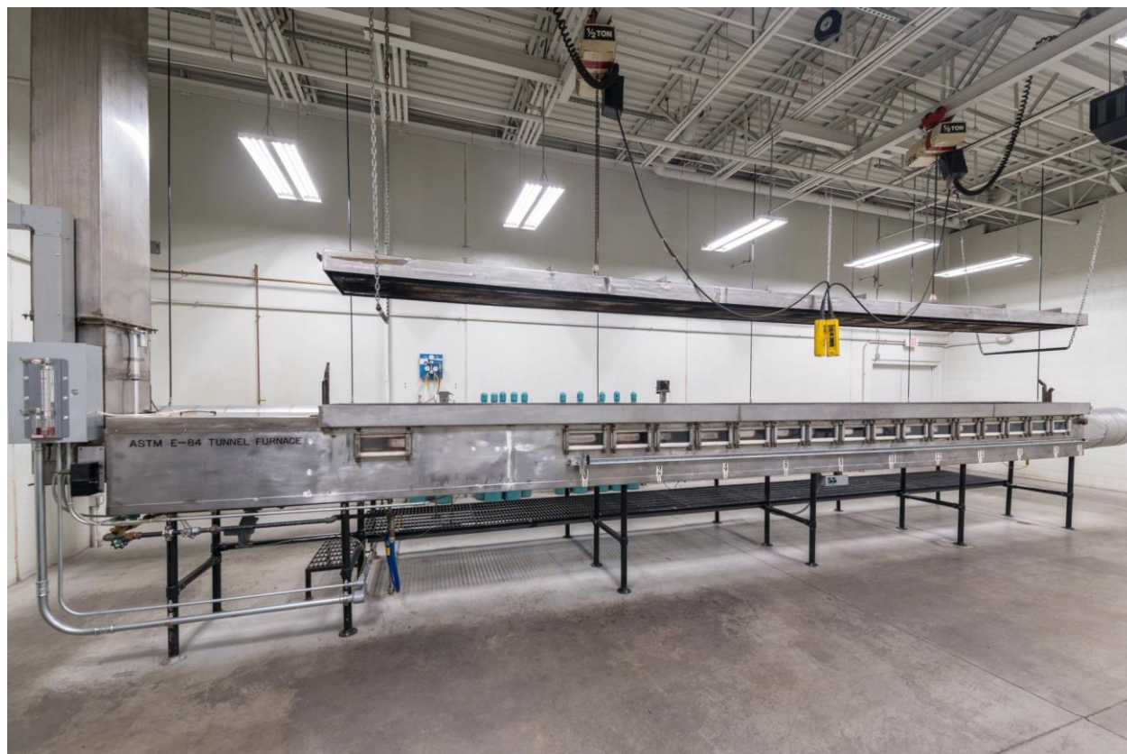
obr. 19 Steinerův tunel (Zdroj: © Capital Testing)
