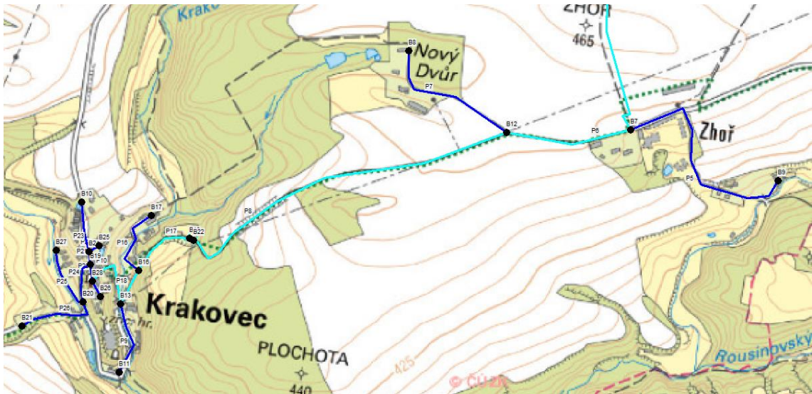
Obrázek 15 - Výstup z programu EPANET, rychlosti (podkladní mapa (20))
