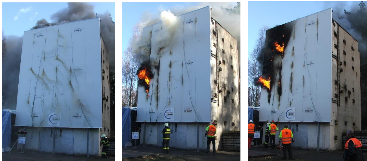
obr. 8: Požární zkouška sendvičových panelů Kingspan ve zkušebně PAVUS v roce 2010 (zdroj: fotoarchiv ČVUT)
