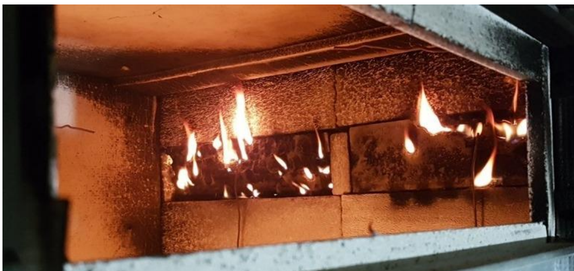
obr. 25: Hořící povrch vzorků TRC po skončení požárního experimentu [45]
