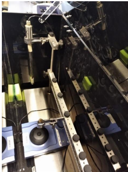
OBRÁZEK 11 NÍZKOTLAKÁ RTUŤOVÁ VÝBOJKA S OPTICKOU LAVICÍ, MODRÝ PŘÍSTROJ JE TŘEPAČKA IKA MS 3 BASIC
