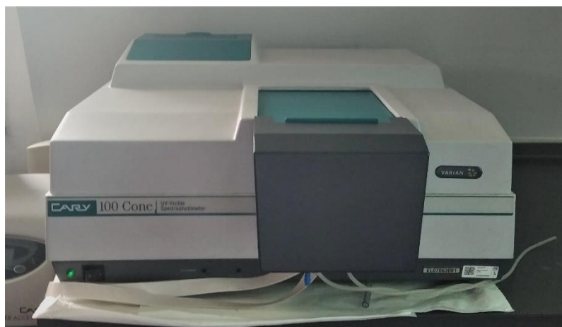
OBRÁZEK 10 UV/VIS SPEKTROFOTOMETR VARIAN CARY 100
