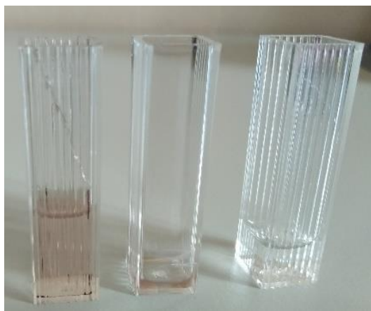
OBRÁZEK 14 PLASTOVÁ KYVETA PRASKLA PO PŘIDÁNÍ PPIX+I-PROH, ČERNÉ TEČKY V KYVETĚ VLEVO JE NEROZPUŠTĚNÝ PPIX
