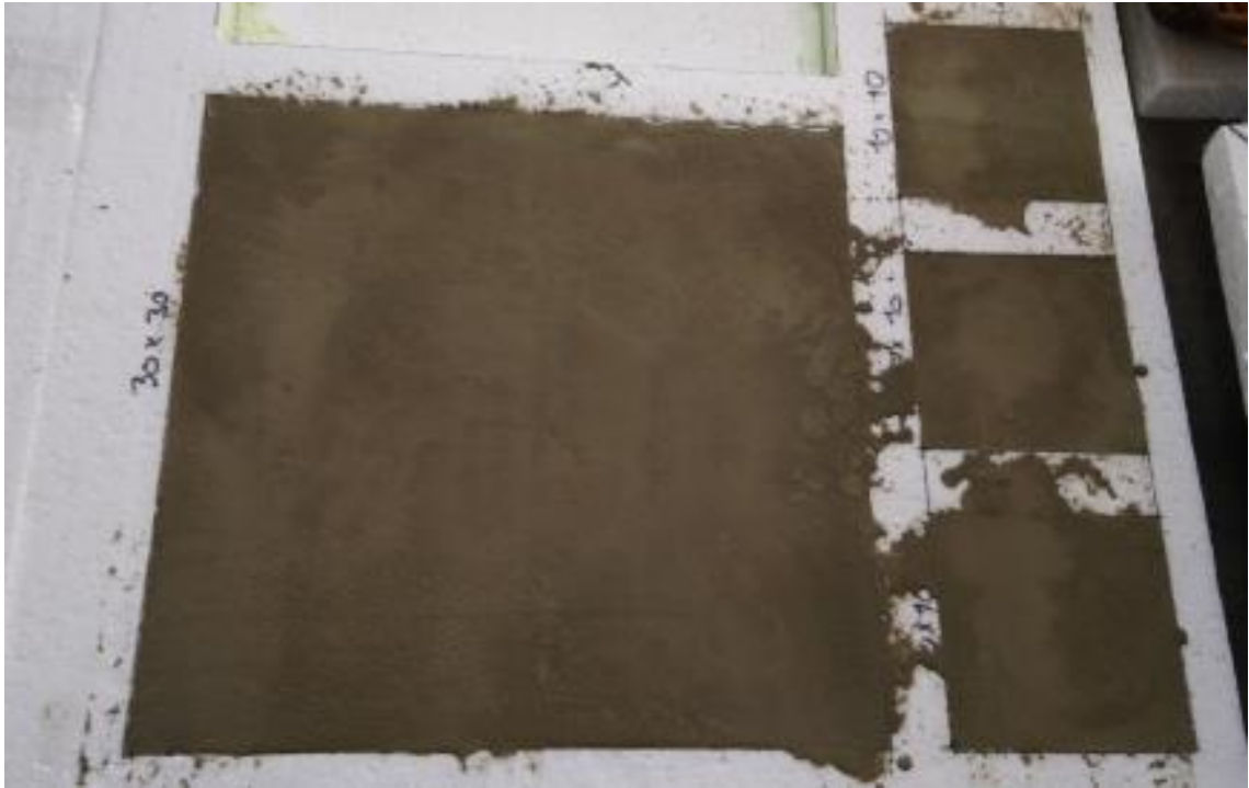
Obr. č. 22 – zkušební vzorky ihned po betonáži (10.09.2021)
