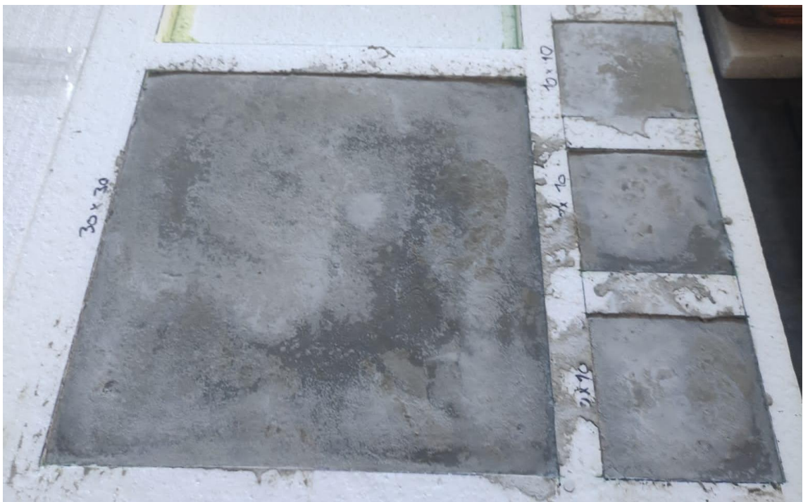
Obr. č. 23 – zkušební vzorky 2 dny po betonáži (12.09.2021)
