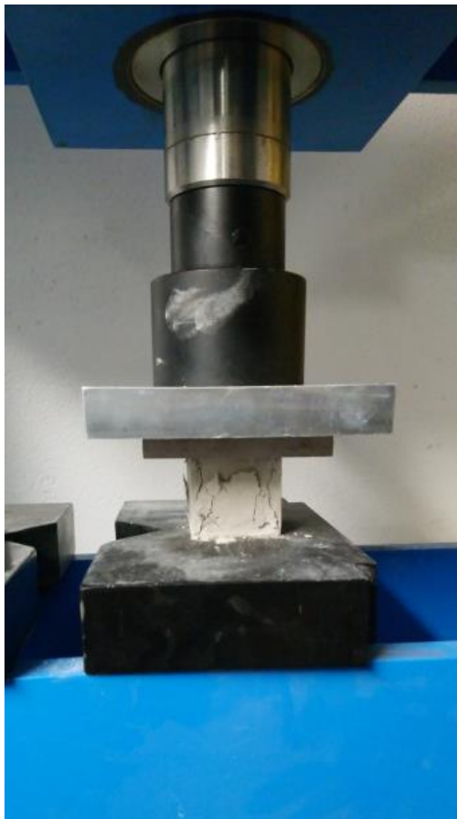
Obr. č. 41 – zkušební krychle při drcení v lisu
