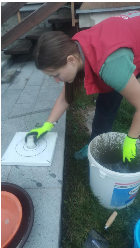
Obr. č. 26 – provádění zkoušky rozlití kužele v domácích podmínkách
