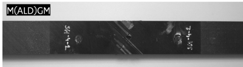
Příloha 13: Příklad hodnocení porušení po provedené zkoušce tahem se zátěžovým cyklem u OH těles
