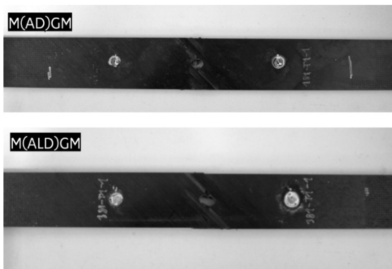
Příloha 17: Příklad hodnocení porušení po provedené zkoušce tahem se zátěžovým cyklem u OH těles
