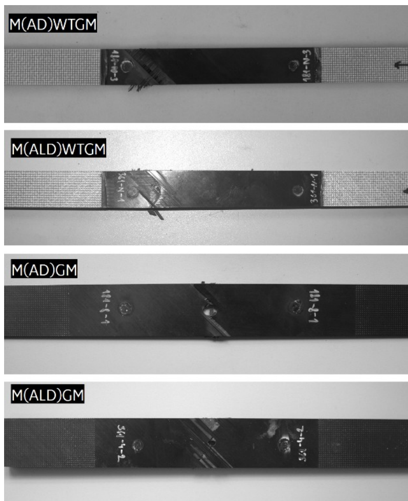
Příloha 11: Příklad hodnocení porušení po provedené zkoušce tahem u těles ve výchozím stavu
