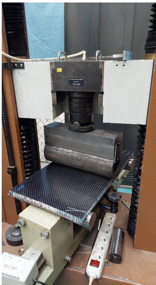
Obr. 57 – Zkušební stroj na tříbodový ohyb se vzorkem
