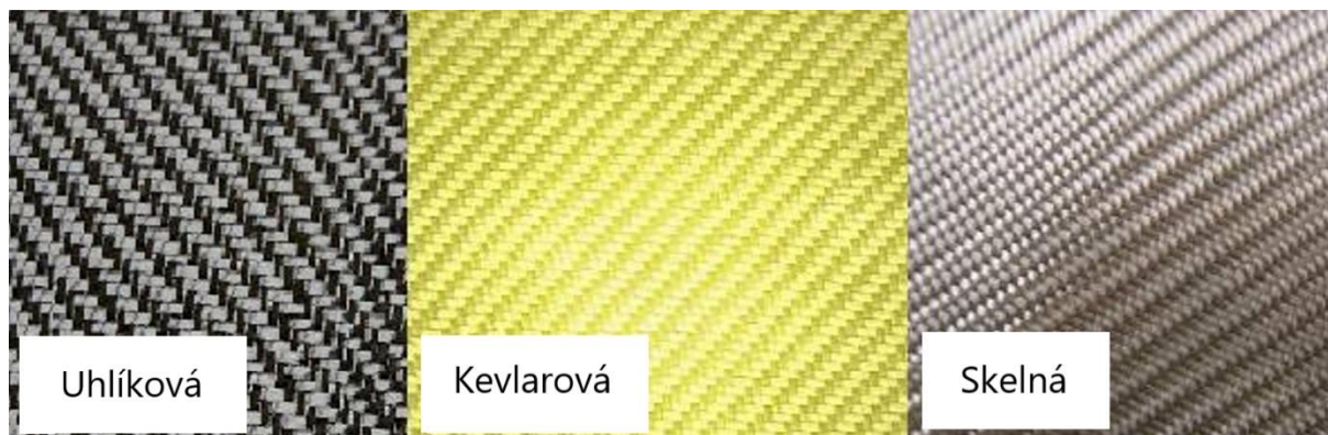
Obr. 16 – Uhlíkové, kevlarové a sklené tkaniny [22]
