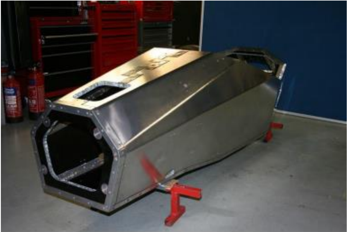
Obr. 5 – Monokok z hliníkových panelů týmu Oxford Brookes Racing [11]
