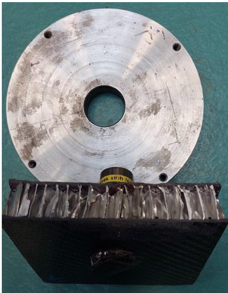
Obr. 61 – Vzorek smykové zkoušky po testu
