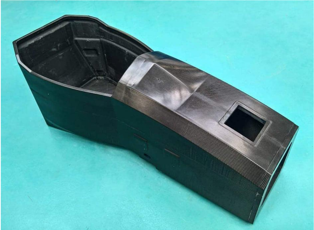
Obr. 6 – Monokok vozu FS.08 týmu CTU CarTech
