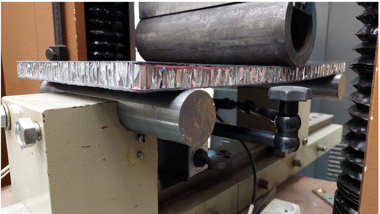
Obr. 59 – Zatížený vzorek po zkoušce, kdy došlo k poruše
