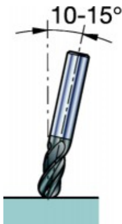
Obr. 19.: Frézování špičkou nástroje [3]
