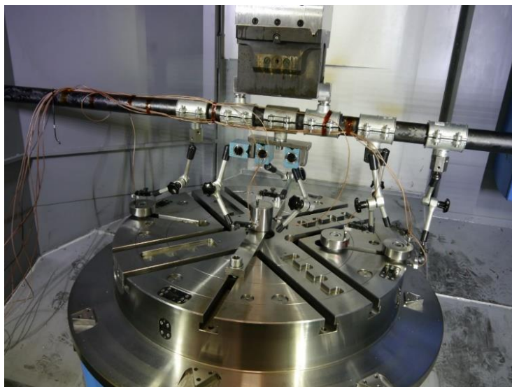
Obrázek 1.8.: Deska řady Powerturn připravená pro měření teplotních deformací způsobených její rotací
