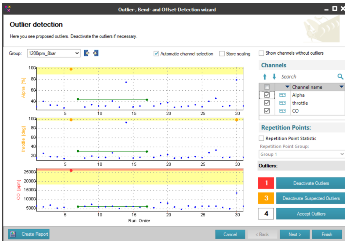
Obr. 45 – Okno funkce Detect Outliers pro detekování odlehlých bodů
