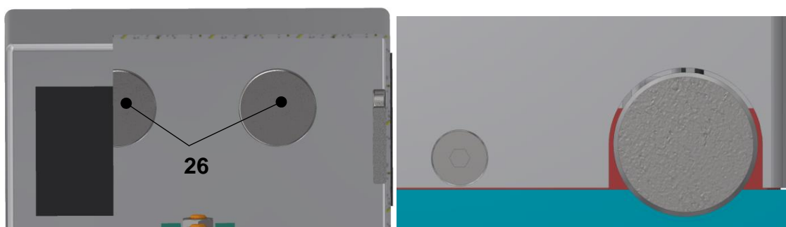
Obrázek 43: Umístění magnetů (vlevo) a mezera určená k vyplnění silikonem (vpravo).
