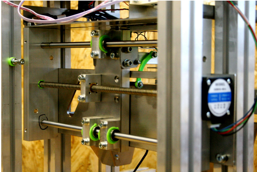
Obr. 3.13: Pohled na vodorovný posuv vozíku, lze vidět pozici krokového motoru, vodicí tyče a lineární kuličková ložiska, také trapézovou závitovou tyč a matici
