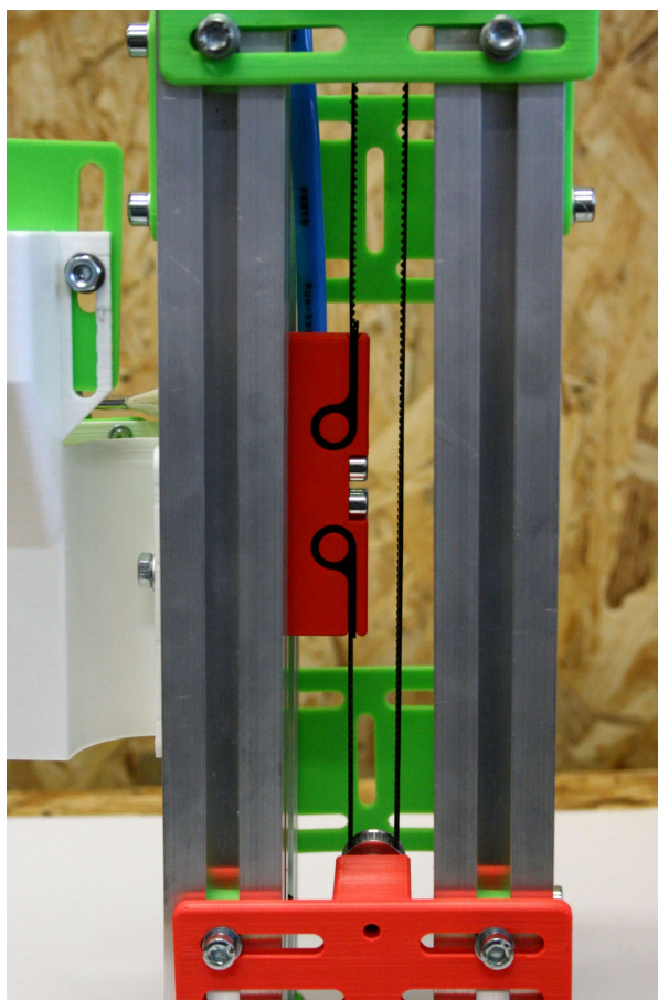
Obr. 3.5: Posuv pohyblivé desky, ozubený řemen je zachycen vlastními zuby kolem čepů ve drážce, napnut je pomocí uchycení spodní řemeničky
