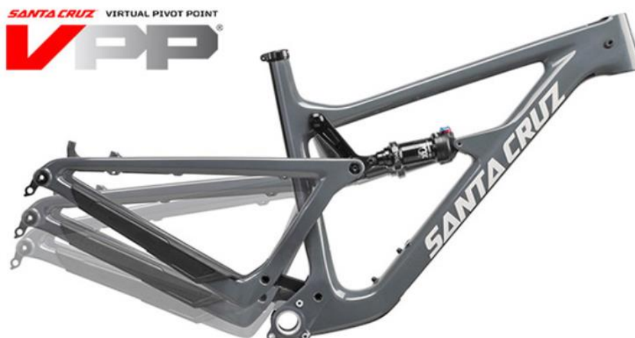
Obrázok 13 Zavesenie zadnej stavby s virtuálnym otočným čapom [7]
