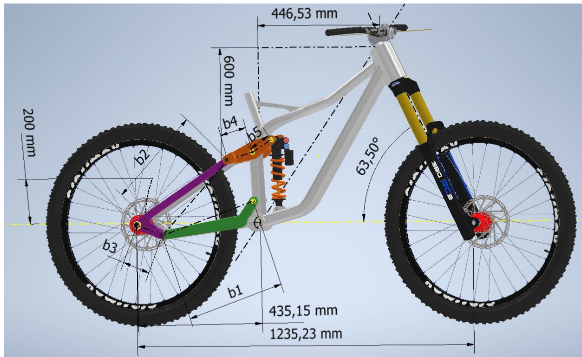
Obrázok 24 Model so štvorčapovým zavesením zadnej stavby od firmy Scott [11]
