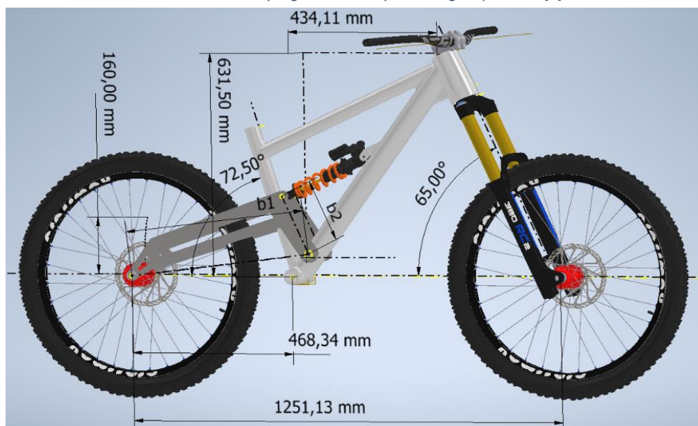
Obrázok 16 Model a vyznačená geometria bicyklu Orange Alpine 160 [8]
