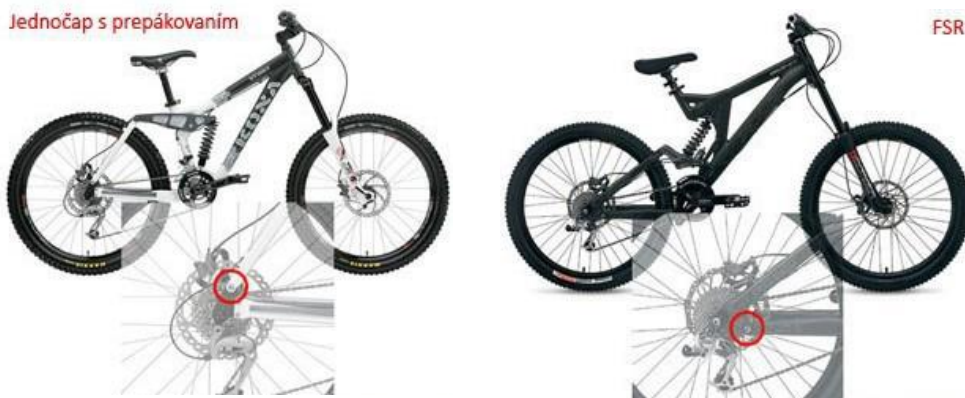
Obrázok 12 Rozdiel medzi prepákovým jednočapovým a štvorčapovým zavesením zadnej stavby [5]
