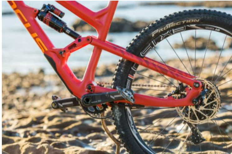
Obrázok 11 Prepákové jednočapové zavesenie zadnej stavby [6]
