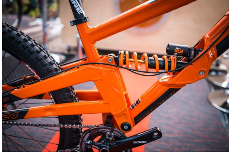
Obrázok 10 Jednočapové zavesenie zadnej stavby [6]
