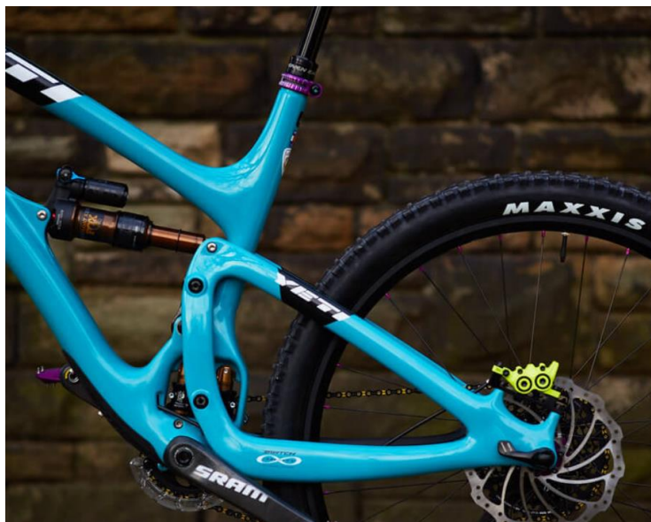
Obrázok 15 Switch infinity od značky YETI [6]
