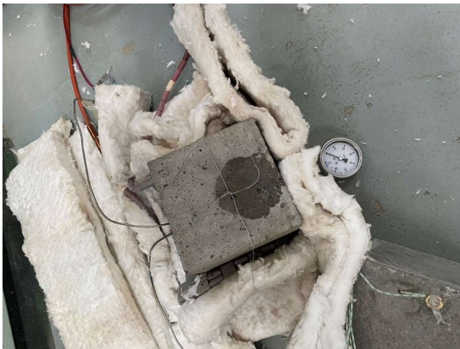
obr. 15: Druhé měření pórového tlaku - fotografie
