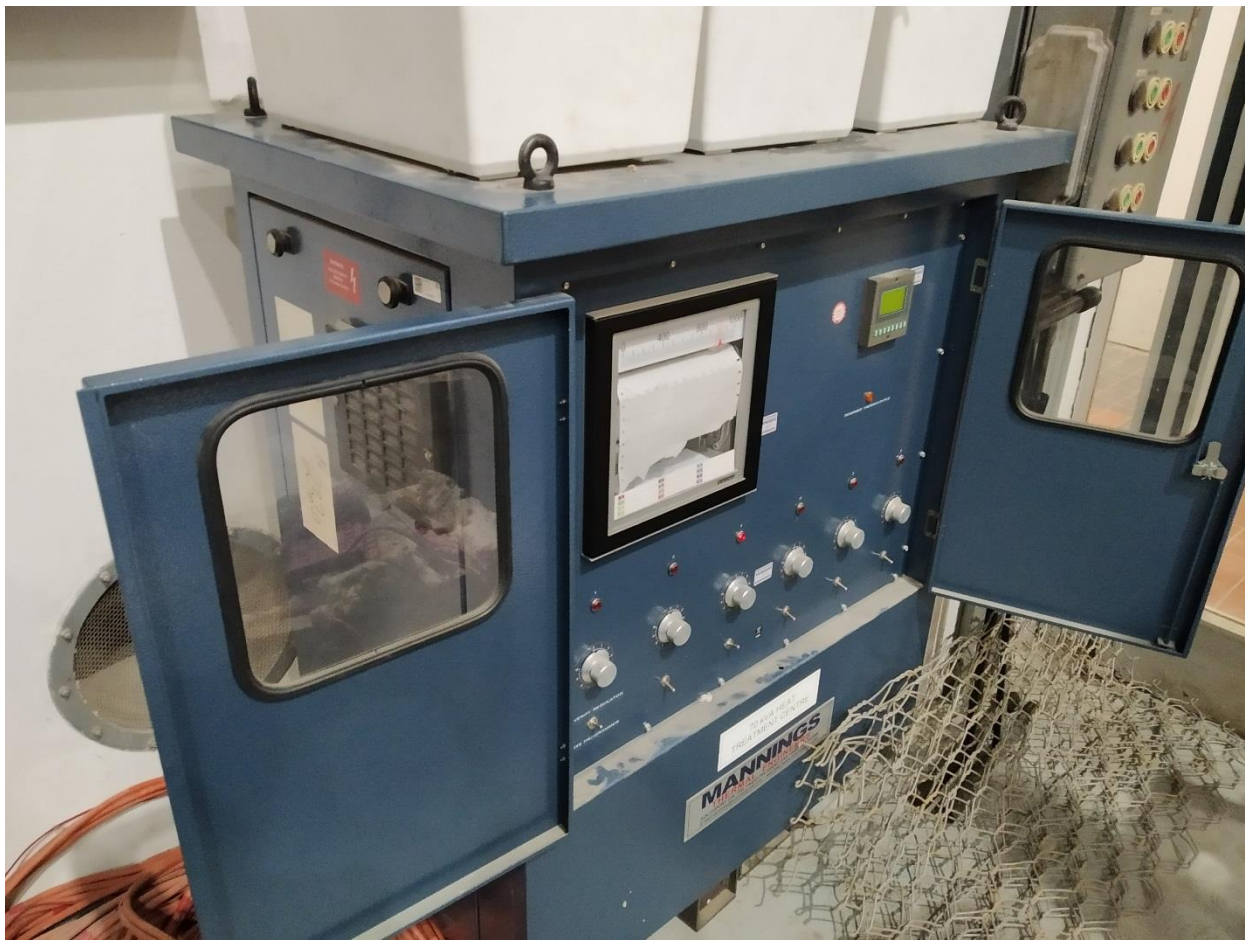
Obr. 15: Zdroj a řídicí jednotka pro ohřev keramických deček
