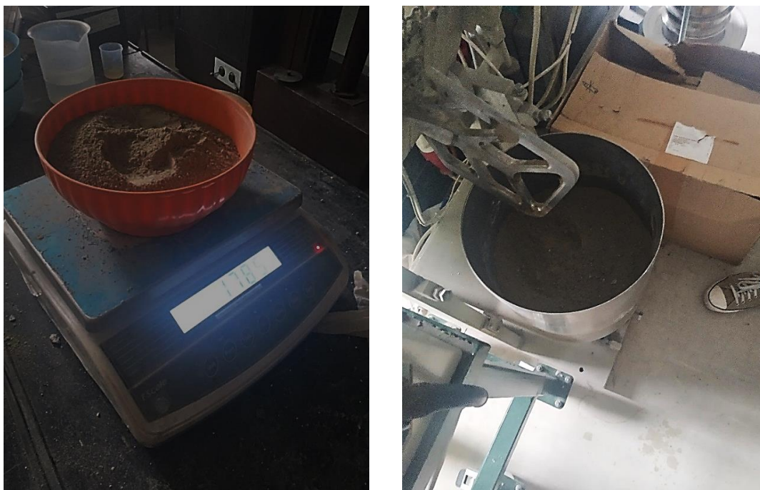
Obr. 10: Vážení složek betonové směsi a proces míchání směsi
