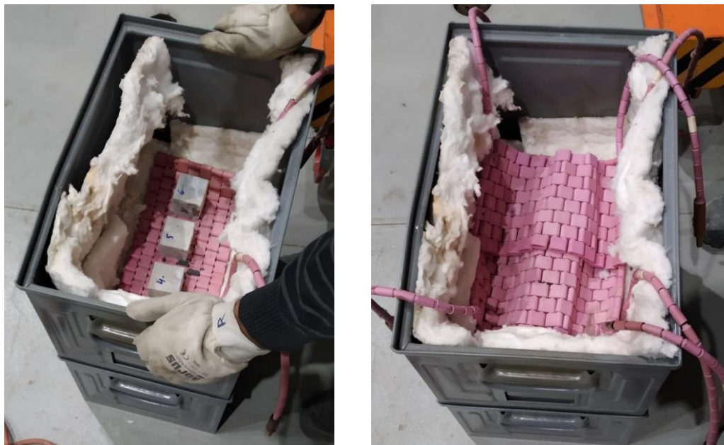
Obr. 27: Vzorky obalené v keramických dečkách
