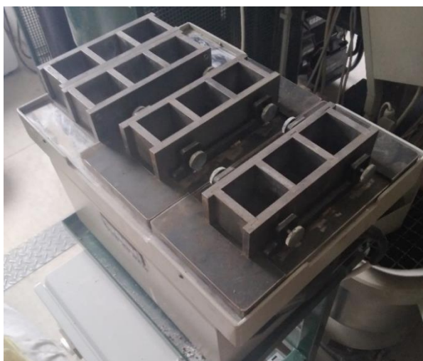
Obr. 11: Ocelové formy připravené na vibračním stole
