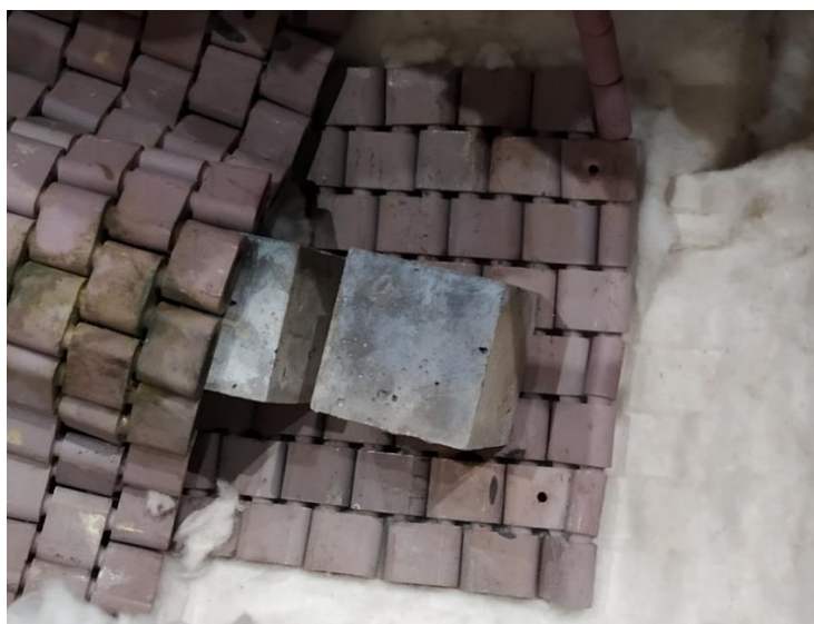
Obr. 30: Vzorek ze skupiny 2 ihned po vystavení vysokými teplotami
