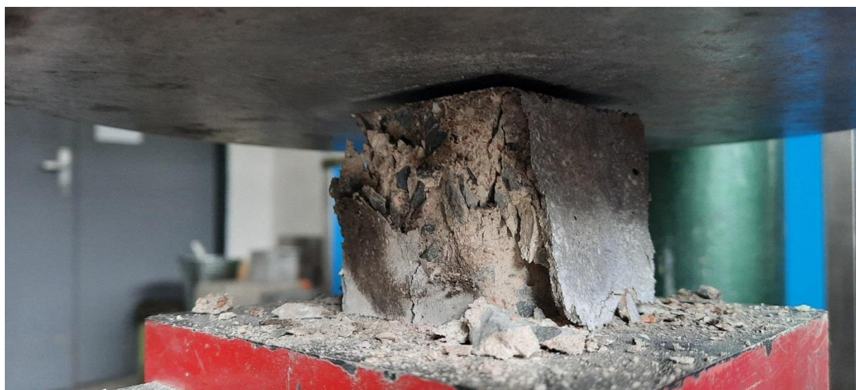
Obr. 43: Porušení vzorku po zkoušce tlakové pevnosti na hydraulickém lisu
