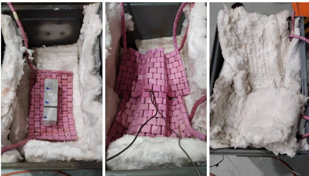
Obr. 31: Uložení vzorků do zahřívacích keramických deček
