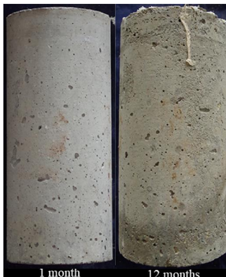
Obr. 7: Betonový vzorek vystavený 10 % roztoku \text{Na}_2\text{SO}_4 po dobu 1 a 12 měsíců. Převzato z [19]
