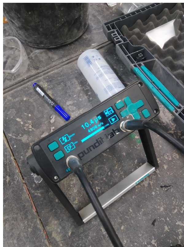
Obr. 22: Měření rychlosti prostupu ultrazvukových vln
