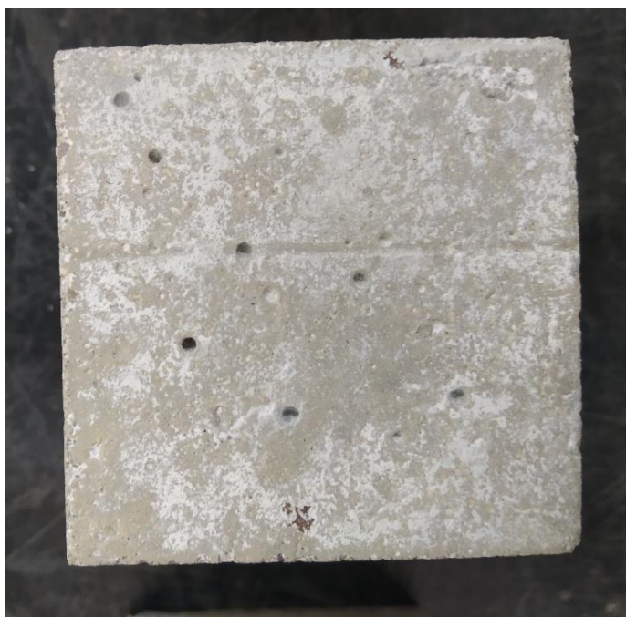
Obr. 19: Povrch vzorku po vystavení roztoku síranu sodného
