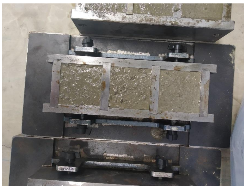
Obr. 13: Zhutněná betonová směs ve formě
