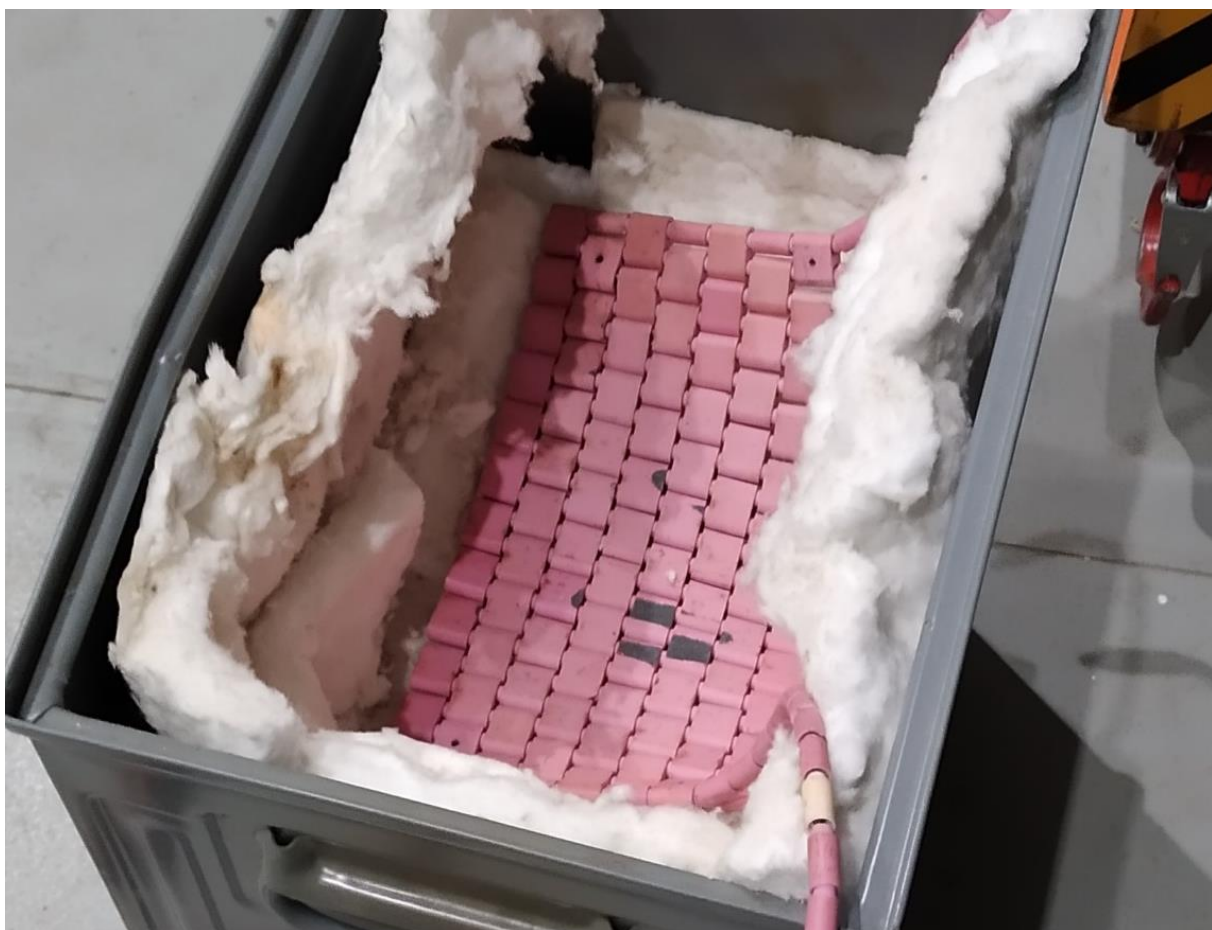
Obr. 14: Keramické dečky pro ohřev vzorků
