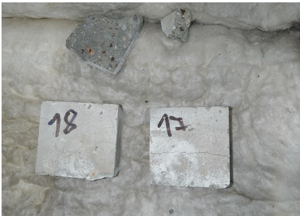
Obr. 41: Tři vzorky ze skupiny 6 ihned po vystavení vysokými teplotami – poškozený povrch vzorků
