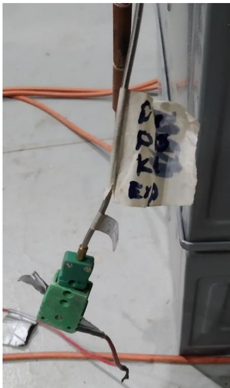
Obr. 16: Termočlánek pro měření teploty vzorků
