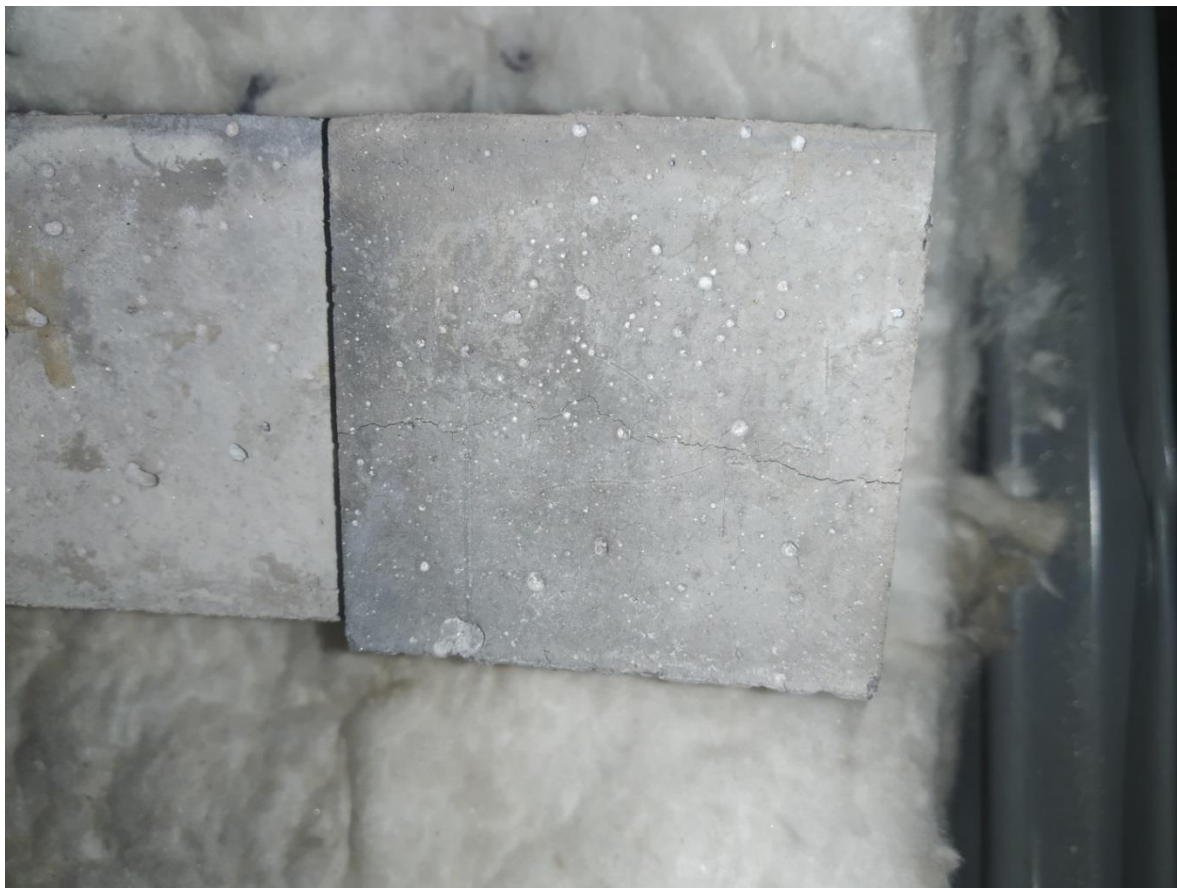
Obr. 38: Vzorek ze skupiny 5 ihned po vystavení vysokými teplotami
