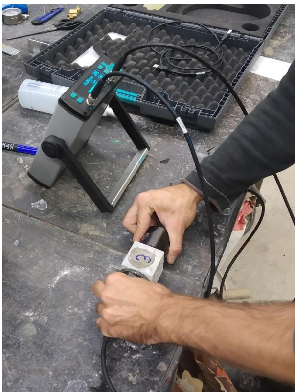
Obr. 22: Měření rychlosti prostupu ultrazvukových vln
