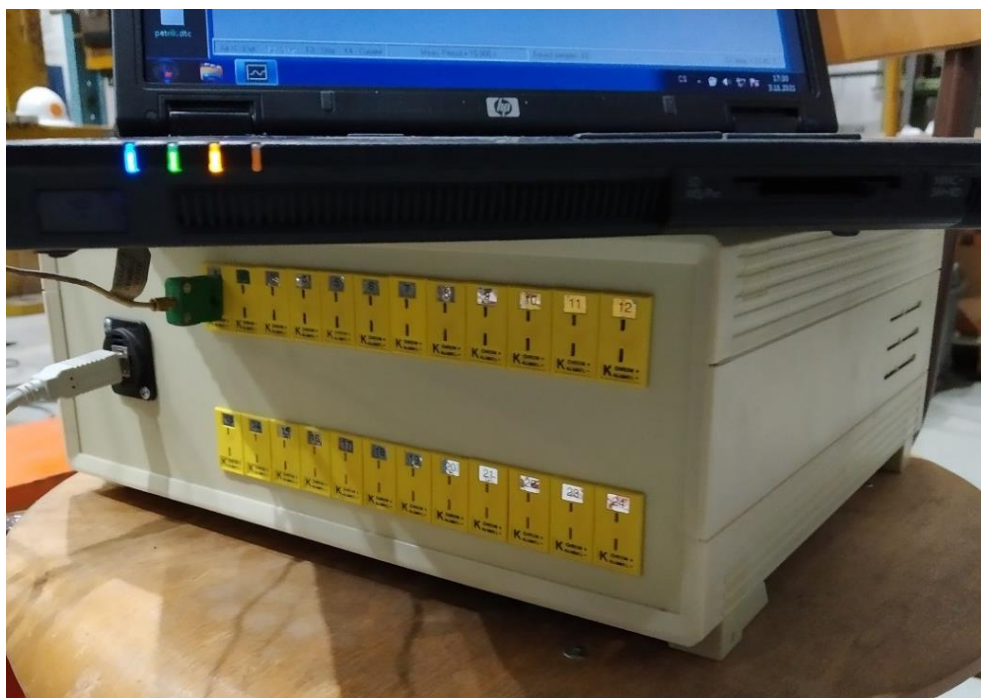
Obr. 17: Datalogger pro příjem a zpracování dat z termočláneků
