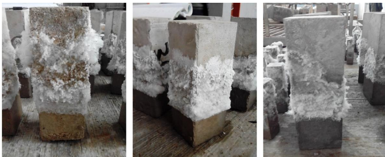
Obr. 3: Krystalizace na povrchu betonových vzorků dle pevnostních tříd. Převzato z [18]
