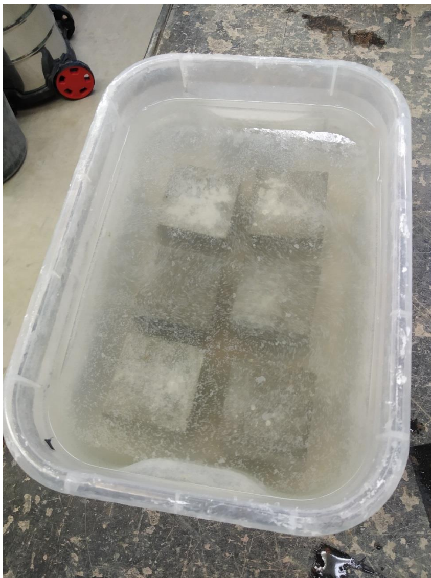
Obr. 35: Zkušební vzorky v nádobě se síranovým roztokem
