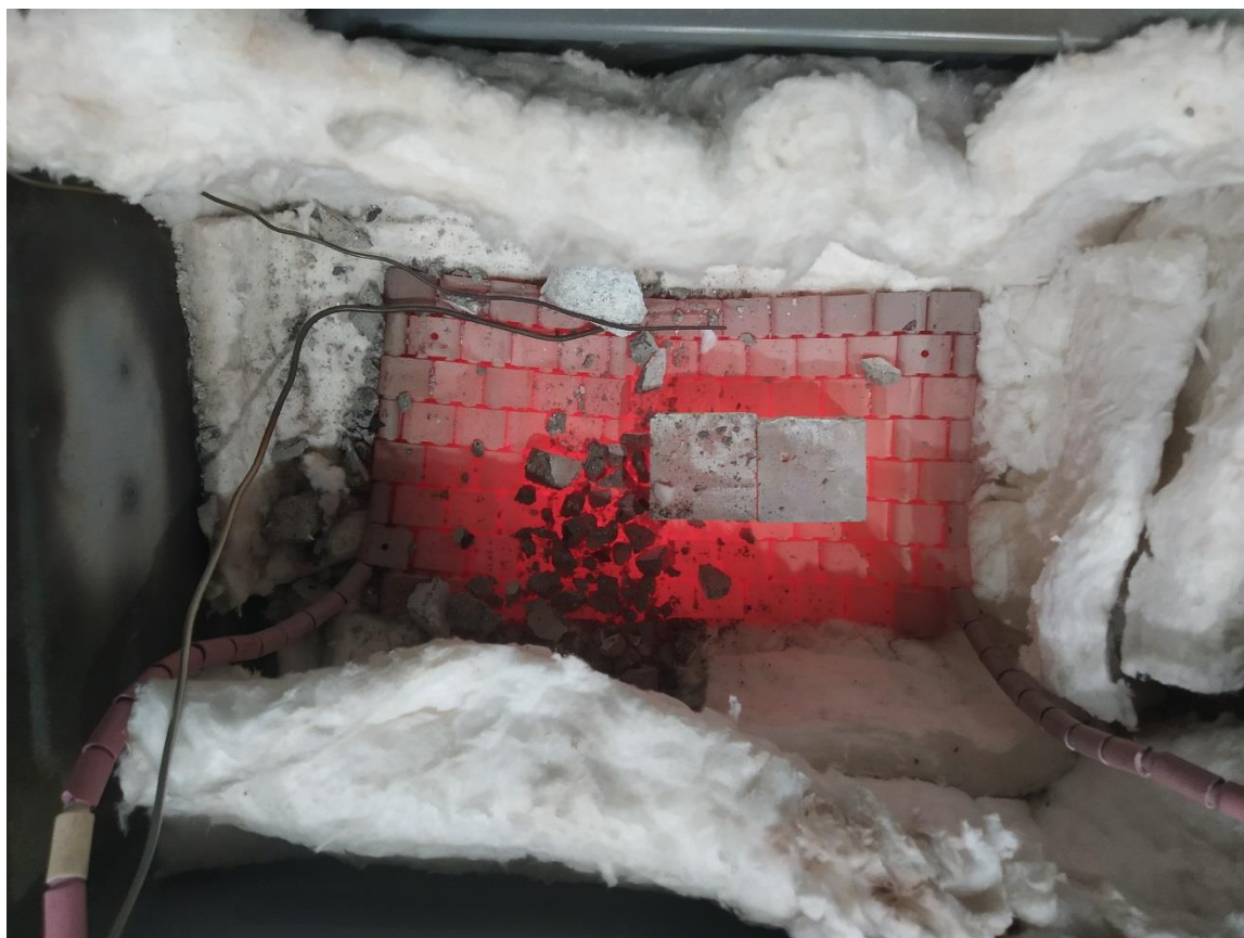
Obr. 40: Vzorky skupiny 6 ihned po procesu zahřívání – vzorek č. 16 roztržštěn
