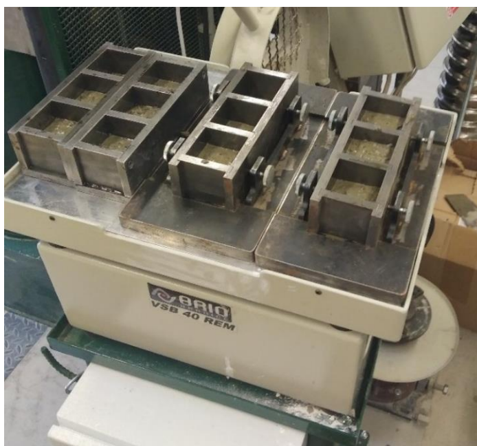
Obr. 12: Vibrování betonové směsi do forem
