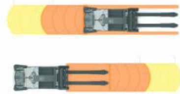
Přední a zadní skenery pro bezpečnou přepravu jmenovitou rychlostí
