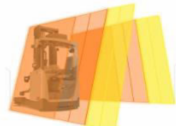
Boční detekce pro překážky vstupující do dráhy z boku
