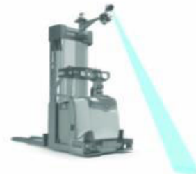
Modré LED světlo upozorňující chodce a řidiče při příjezdu ze skrytého místa
