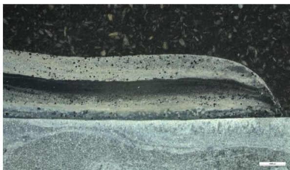
Obrázek 30 Makrostruktura vzorku č. 5 (P)
