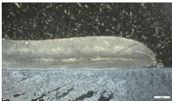
Obrázek 24 Makrostruktura vzorku č. 2(P)
