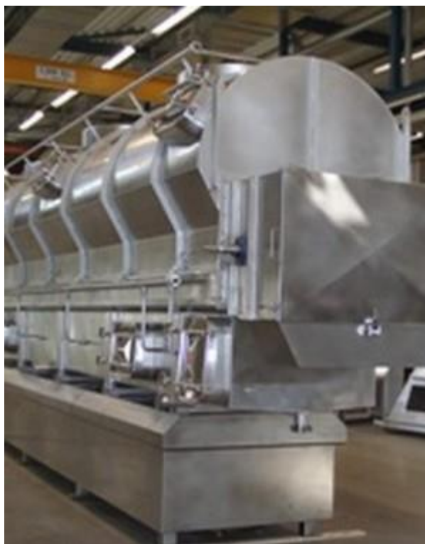
Obrázek 15: Kontinuální fluidní sušárna [17]
