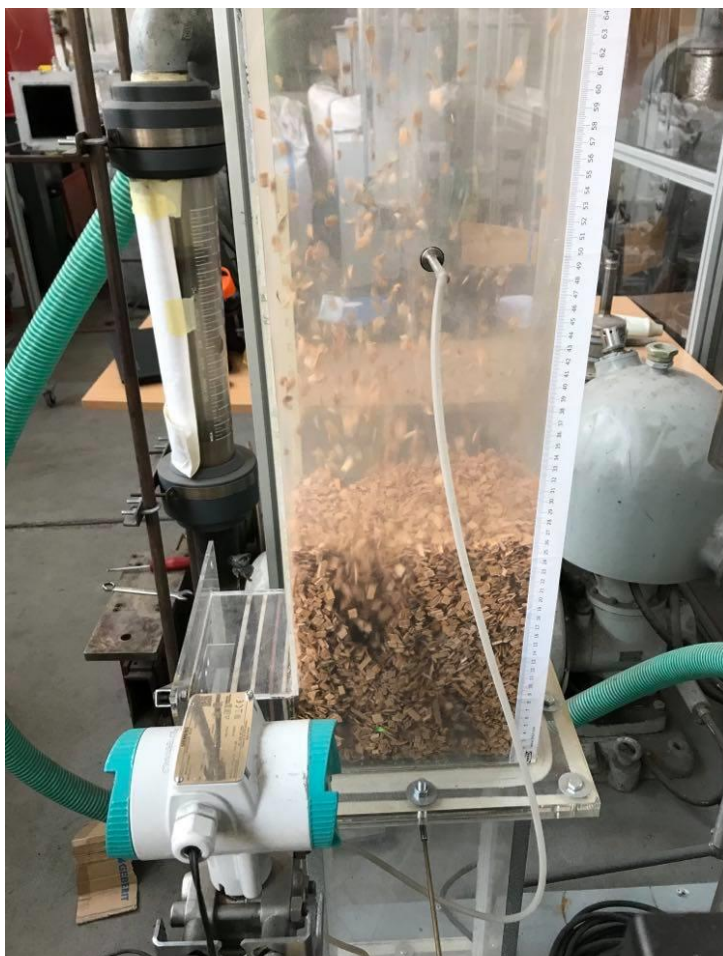
Obrázek 37: Olše 1, tvoření kanálů při fluidování
