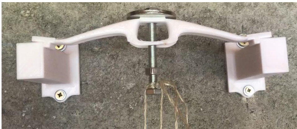
Obrázek 61 Způsob realizace zkoušky ohybem
