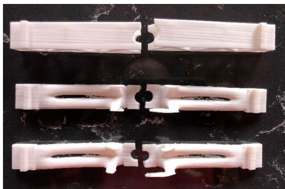
Obrázek 62 Pohled zdola na díly po destrukci
