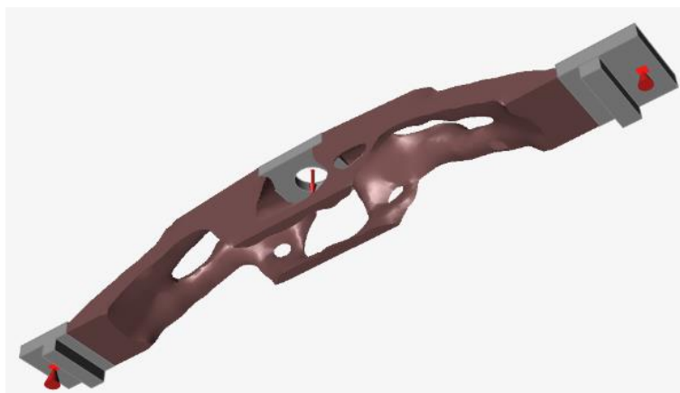
Obrázek 38 Optimalizovaná součást pro tříbodový ohyb – pohled ze zdola
