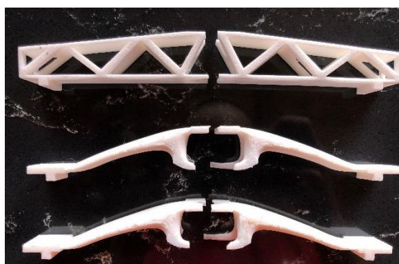
Obrázek 63 Pohled z boku na díly po destrukci
