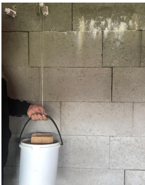
Obrázek 56 Zatěžování vetknutého nosníku
