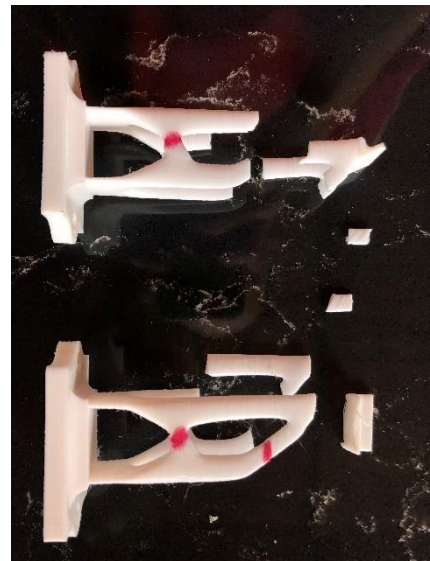
Obrázek 60 Topologická optimalizace vetknutého nosníku po deformaci
