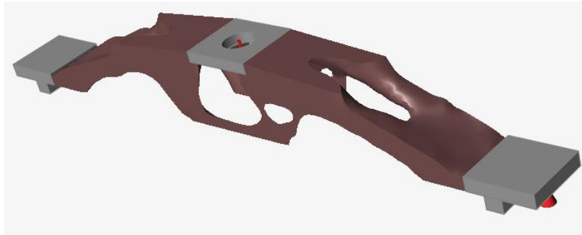
Obrázek 36 Optimalizovaná součást pro třibodový ohyb – obecný pohled
