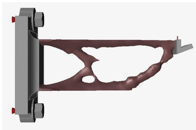
Obrázek 33 Součást vetknutý nosník – topologická optimalizace přes kritérium minimální hmotnosti, pohled z boku
