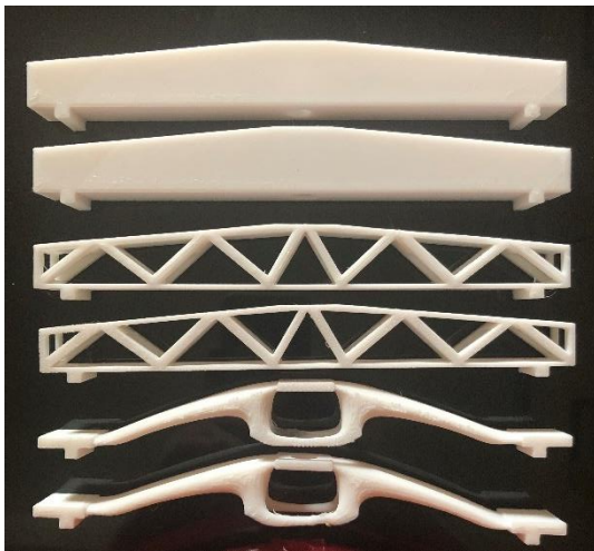
Obrázek 53 Vytisknuté varianty součásti pro tříbodový ohyb
