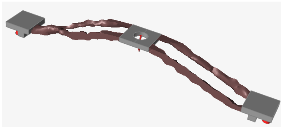
Obrázek 31 Součást pro tříbodý ohyb, topologická optimalizace přes kritérium minimální hmotnosti
