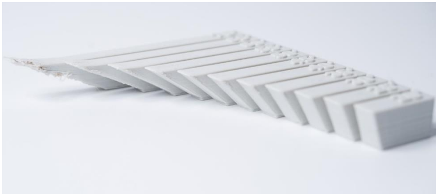
Obrázek 10 Spektrum tisknutelných úhlů 20^\circ - 70^\circ [10]
