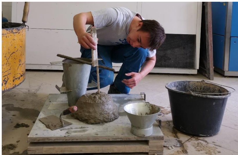
Obr. 6.3: Stanovení konzistence betonu
