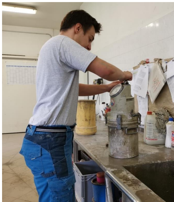
Obr. 6.4: Stanovení obsahu vzduchu v čerstvém betonu
