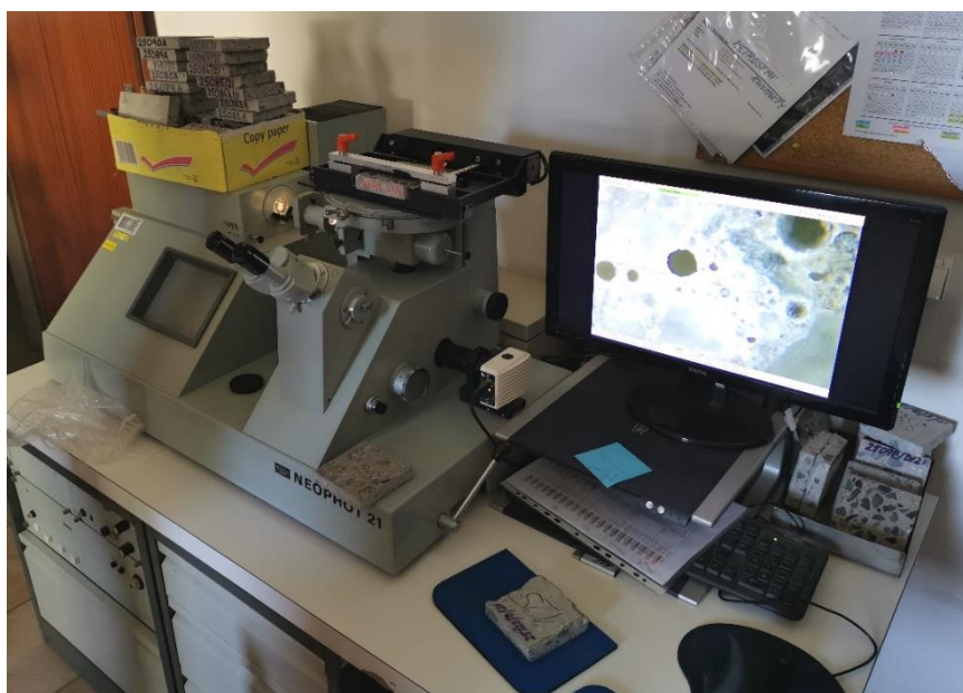
Obr. 6.11: Mikroskop + PC pro vyhodnocení SPF
