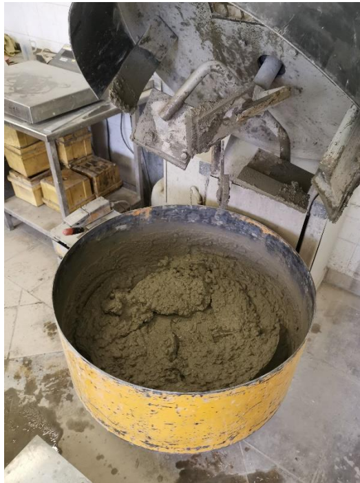
Obr. 6.2: Míchání betonové směsi v míchačce
