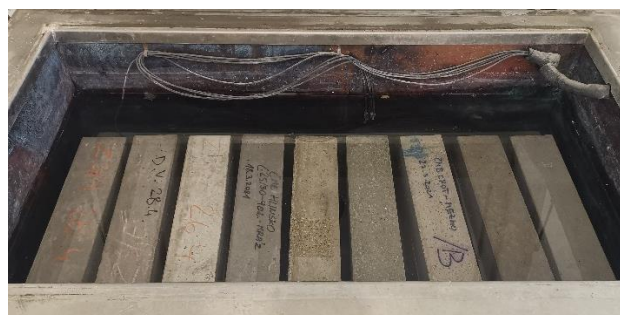
Obr. 4.6: Zkušební tělesa v mrazicím boxu
