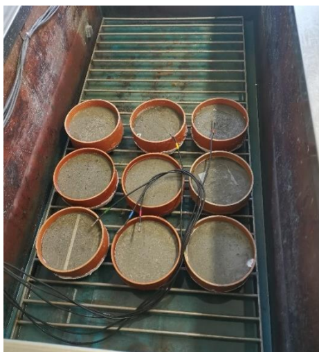
Obr. 6.6: Uložení zkušebních těles do mrazicího boxu
