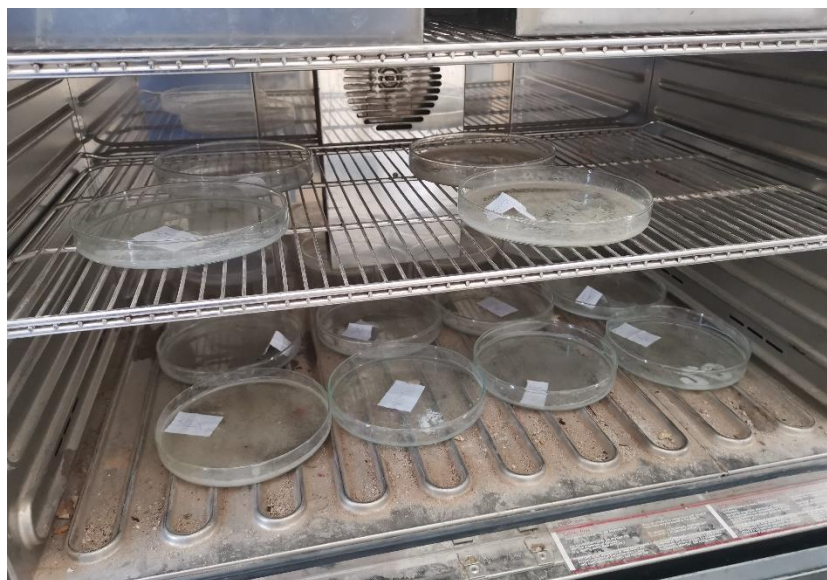
Obr. 6.8: Sušení uvolněných částí při 105 °C
