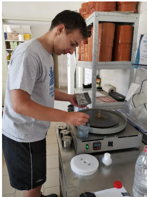
Obr. 6.10: Příprava vzorků SPF - leštění
