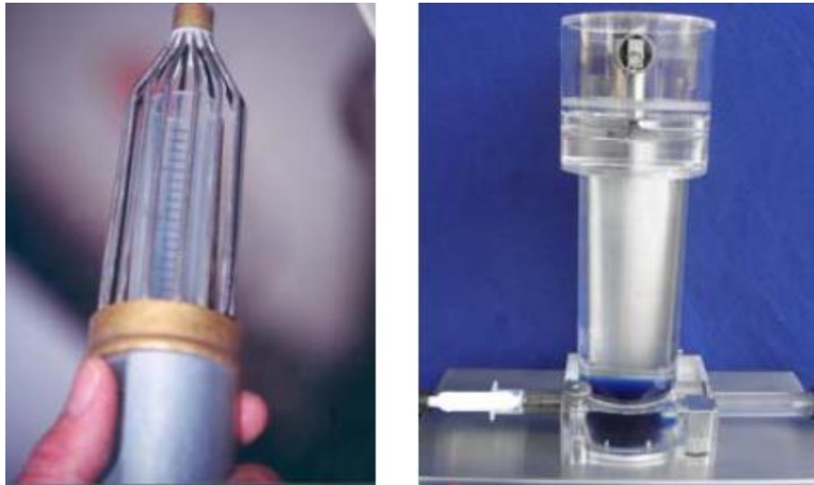
Obr. 3.2: Drátěná klec + vstřík vzorku [21]
