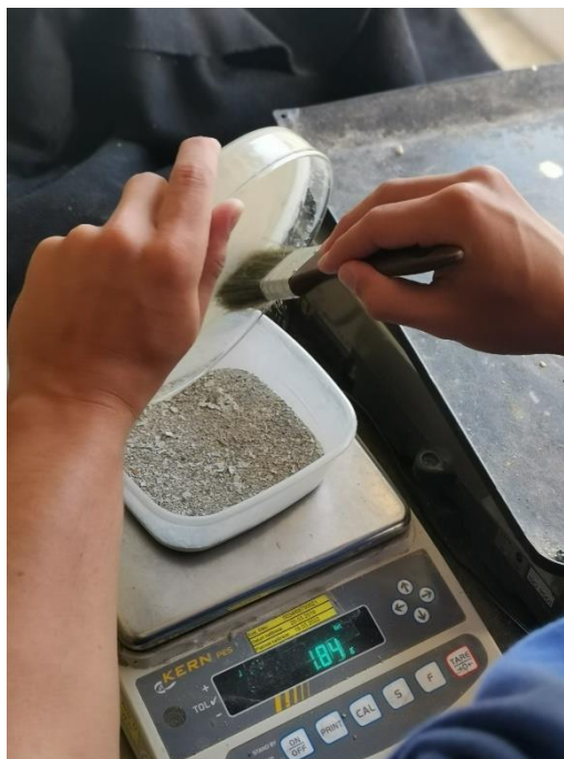
Obr. 6.9: Vážení uvolněných částic
