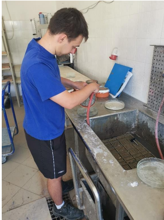
Obr. 6.7: Omývání uvolněných částic betonu
