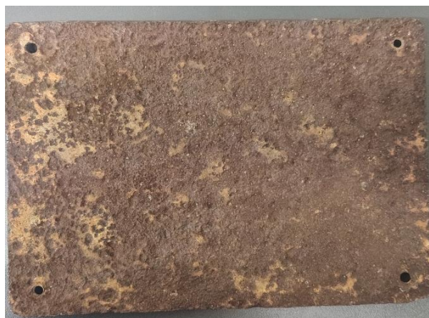
Obrázek 9: Zadní strana cedule s korozí
