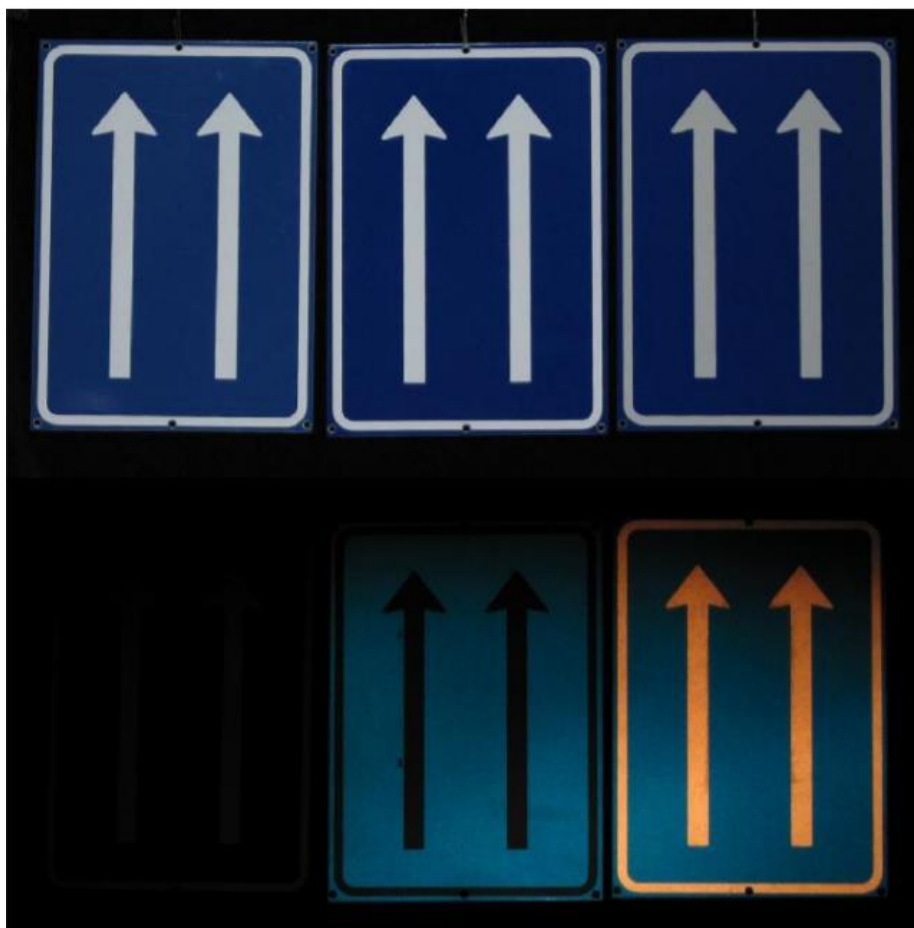
Obrázek 17: Viditelnost značení v závislosti na fólii [40]
