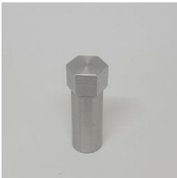
Obr. 13: Testovací adaptér (A2) sloužící k otestování hliníku jako materiálu pro provozní adapter [autor]
