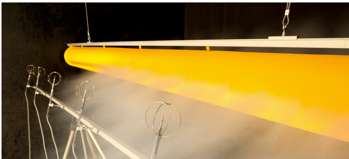
Obrázek 19 – Ukázka distribuce vzduchu vyústkou (kouřová zkouška) [34]
