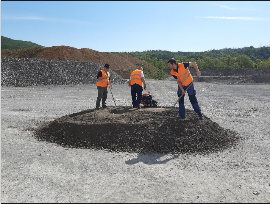
První měření v kamenolomu Zbraslav, příprava zkušební vrstvy z ŠD 0/32
