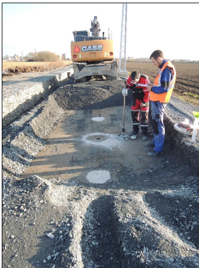
Měření na trati v Uničově, kontrolní rázové zatěžovací zkoušky na úrovni ZP
