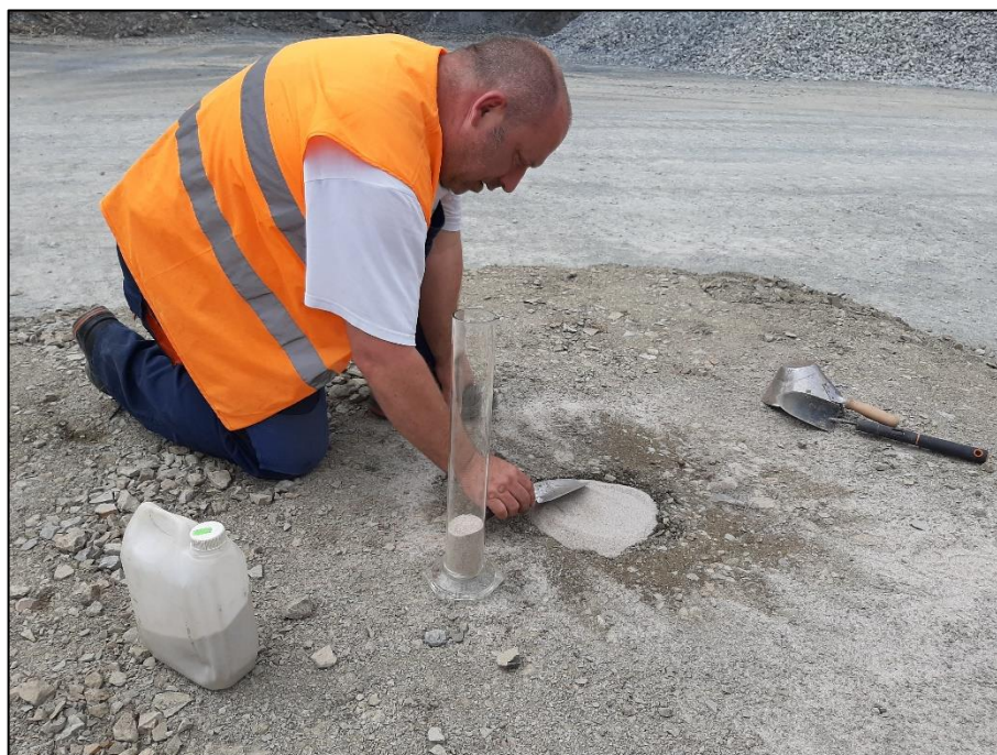
První měření v kamenolomu Zbraslav, stanovení objemu odebraného vzorku ŠD 0/32
