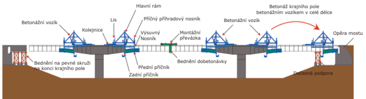
Obr. 32 - Schéma provádění letmé betonáže [53]
