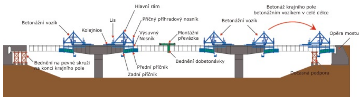
Obrázek 2.12: Nákres letmé betonáže [35]
