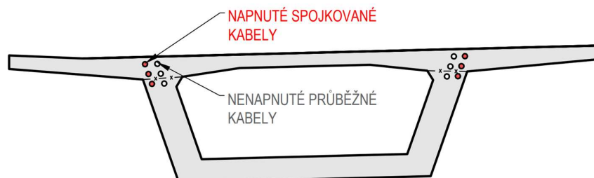
Obrázek 138: Vzdorující průřez nad podporou P5 ve fázi 1-3
