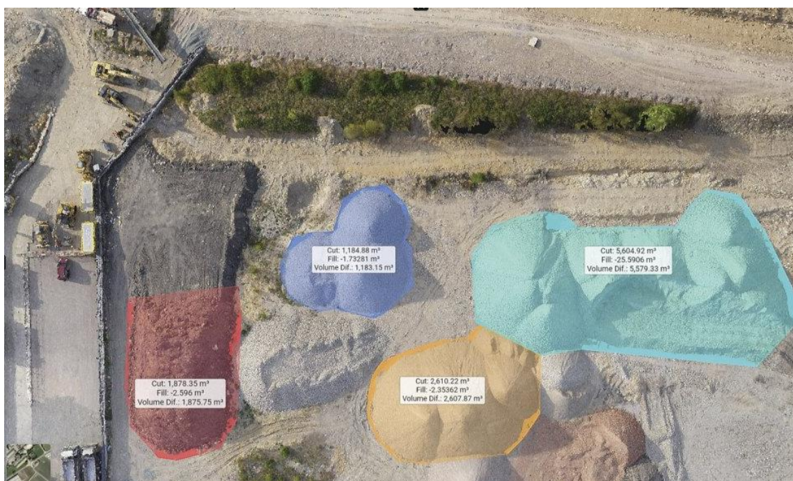
Obrázek č. 10 – Ilustrace použití technologie skenování dronem pro zaměřování objemů deponií materiálů [81]
