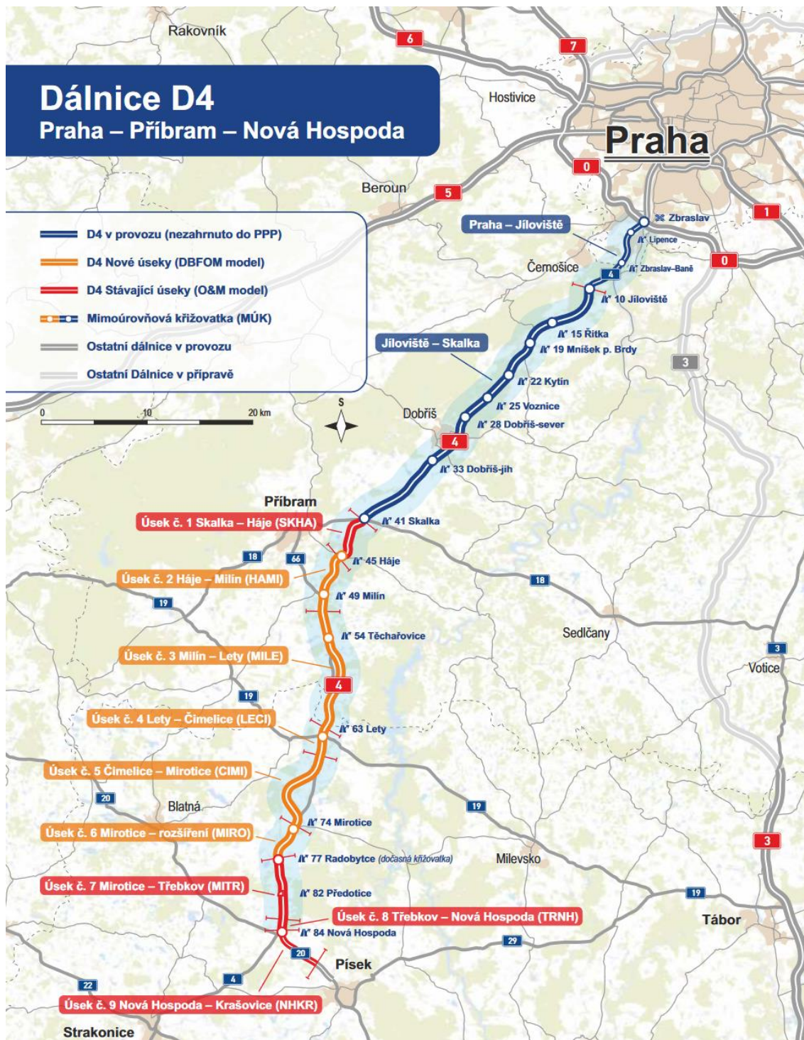
Obrázek č.12 – Přehled stavby nového úseku dálnice D4 [103]
