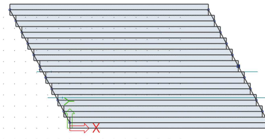
Obrázek 54 Deskostěnový model pole mostu X525 bez podepření
