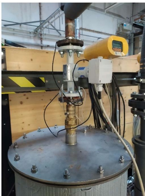
Obr. 51 Pohled na průtokoměr a teplotní čidla na vstupu do akumulátoru [29]
