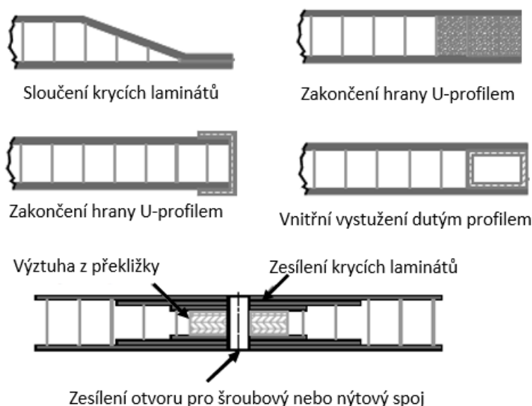
Obrázek 9 Technologická řešení zakončení a spojů sendvičových materiálů
