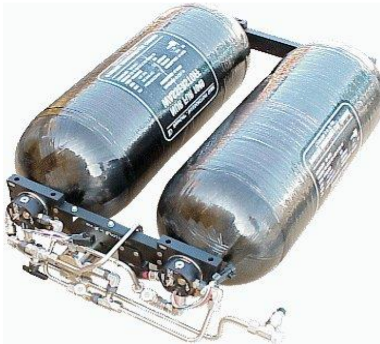
Obr. 13: Vodíkové nádrže používané v současnosti ve vozidlech na vodíkový pohon, zdroj [41]
