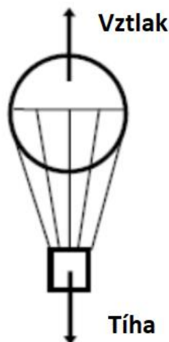
Obrázek 2: Princip letu balónu [1]
