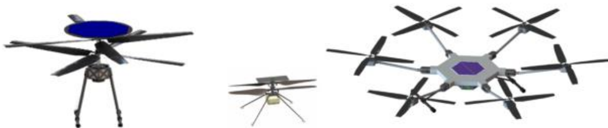
Obrázek 20: Porovnání budoucích konceptů s Ingenuity (vlevo Mars Science helicopter-coaxial, vpravo Mars Science helicopter-hexacopter) [11]
