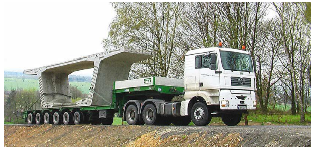
Obr. 54 Silniční přeprava segmentů [15]
