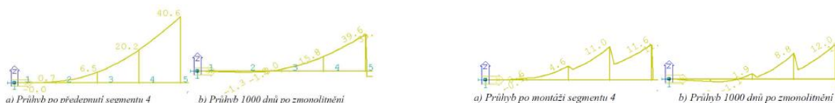
Obr. 75 Průběh deformací: Betonáž do tečny (vlevo), Betonáž do správné nivelety (vpravo) [7]
