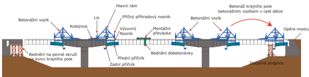
Obr. 58 Prvky při výstavbě technologii letmé betonáže [21]
