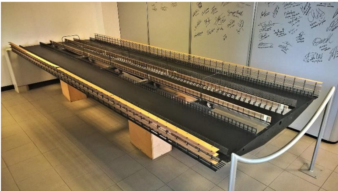
Obrázek 43: Model mostovky pro větrný tunel vytvořen Milánskou polytechnickou univerzitou.
