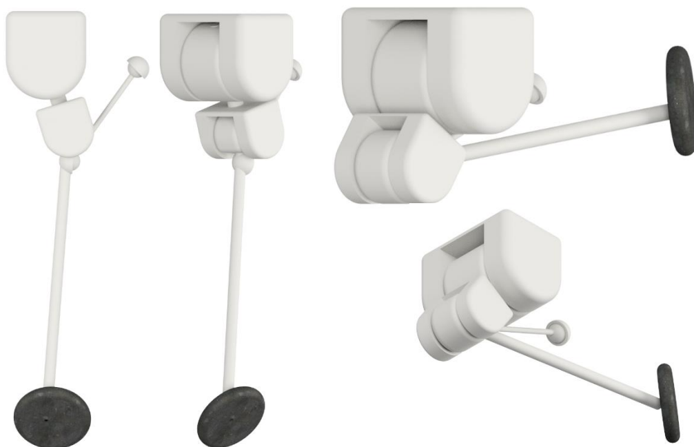
Obr.50 3D model podvozkových noh v jejich krajních polohách
