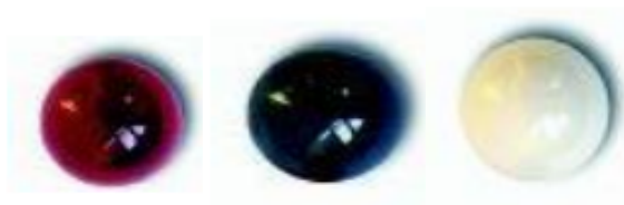
Obrázek 9- Materiály kuliček (rubín, nitrid křemíku, zirkonium) [11]
