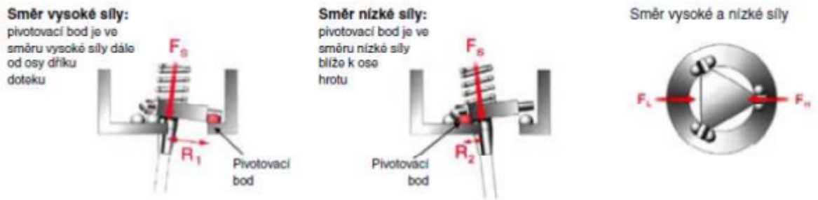
Obrázek 3-Princip měření kinematické sondy [6]
