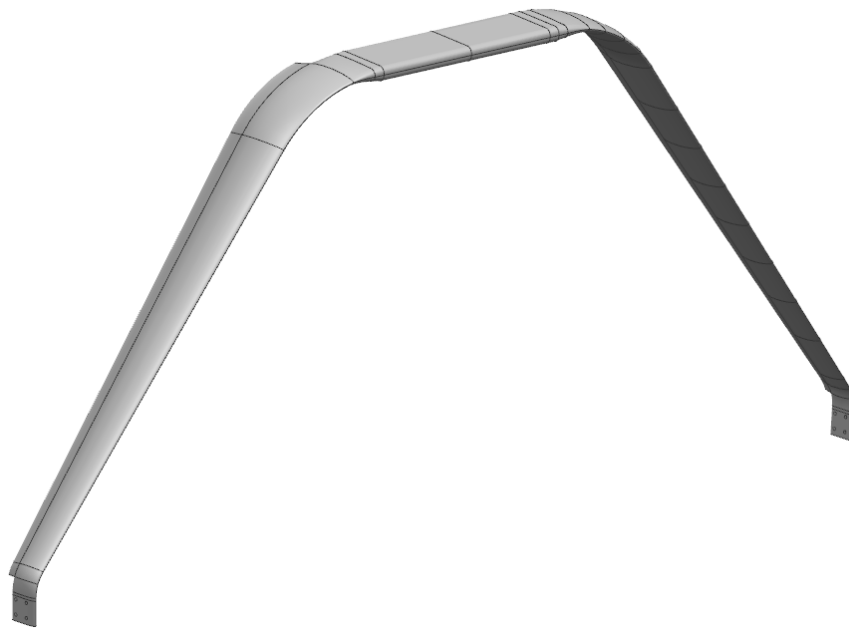
Obr. 5 Model pružinové nohy zpracovaný v systému Siemens NX, koncept A
