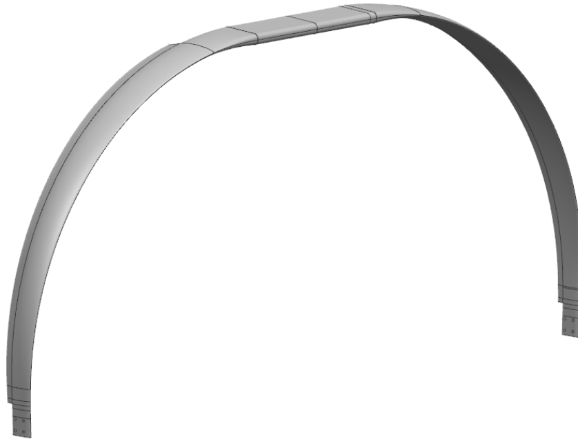
Obr. 7 Model pružinové nohy zpracovaný v systému Siemens NX, koncept C Schéma obsahující hlavní rozměry nohy je znázorněno na Obr. 8.
