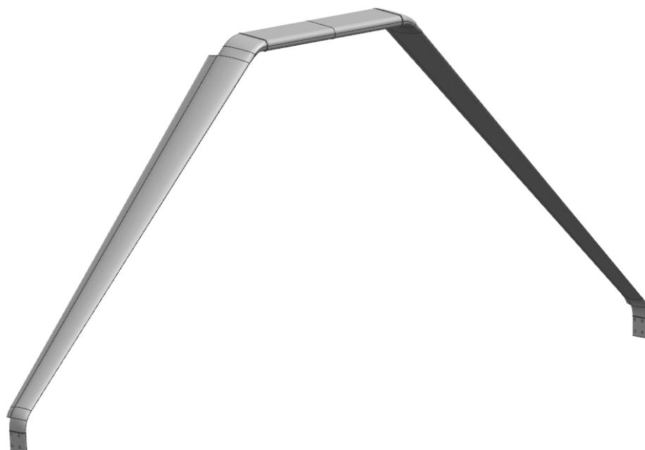
Obr. 6 Model pružinové nohy zpracovaný v systému Siemens NX, koncept B
