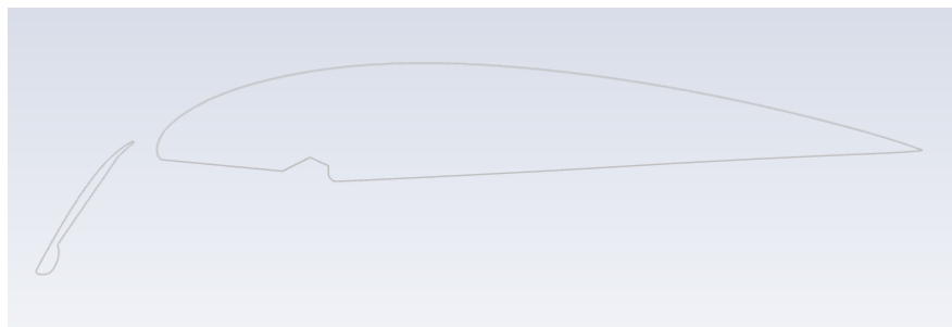
Obrázek 2.14: Konečná poloha Krügerovy klapky a profilu po vysunutí
