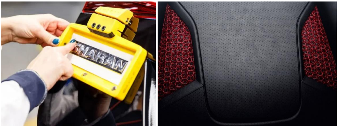
Obr. 4 Montážní přípravek (šablona) vyrobená pomocí 3D tisku (vlevo) a výroba sedadla na míru s využitím plastového 3D tisku (vpravo) [15] [17]
