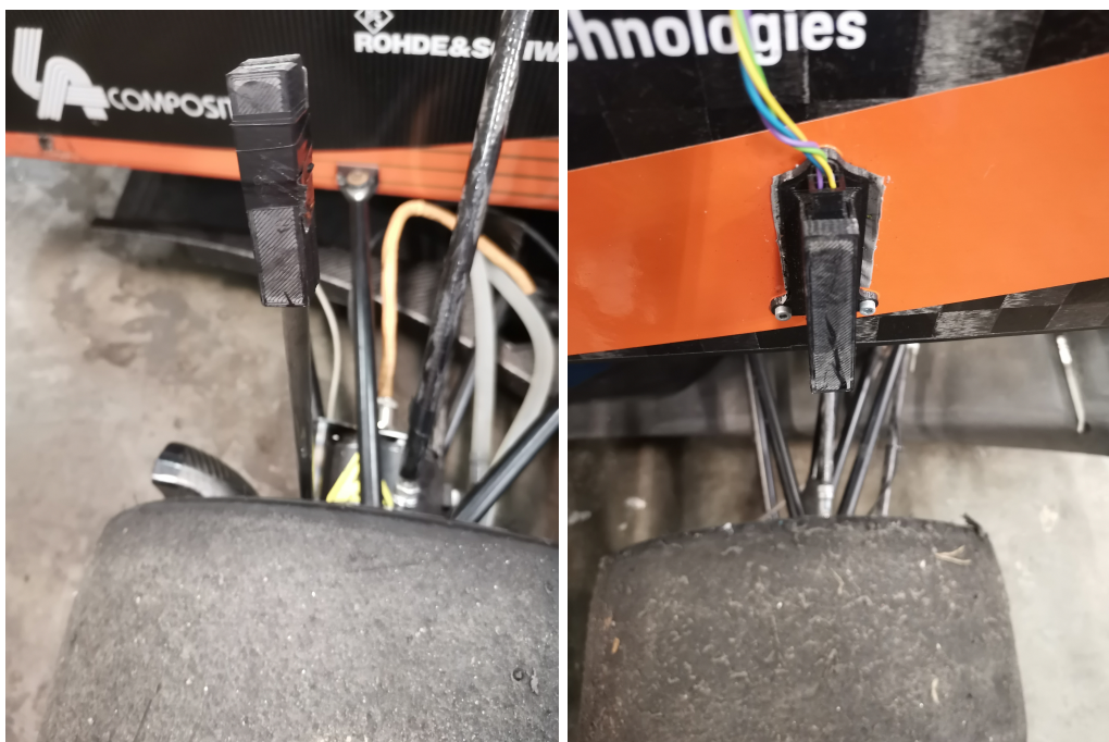
(a) Fotografie uchycení senzoru předních pneumatik. (b) Fotografie uchycení senzoru zadních pneumatik.
