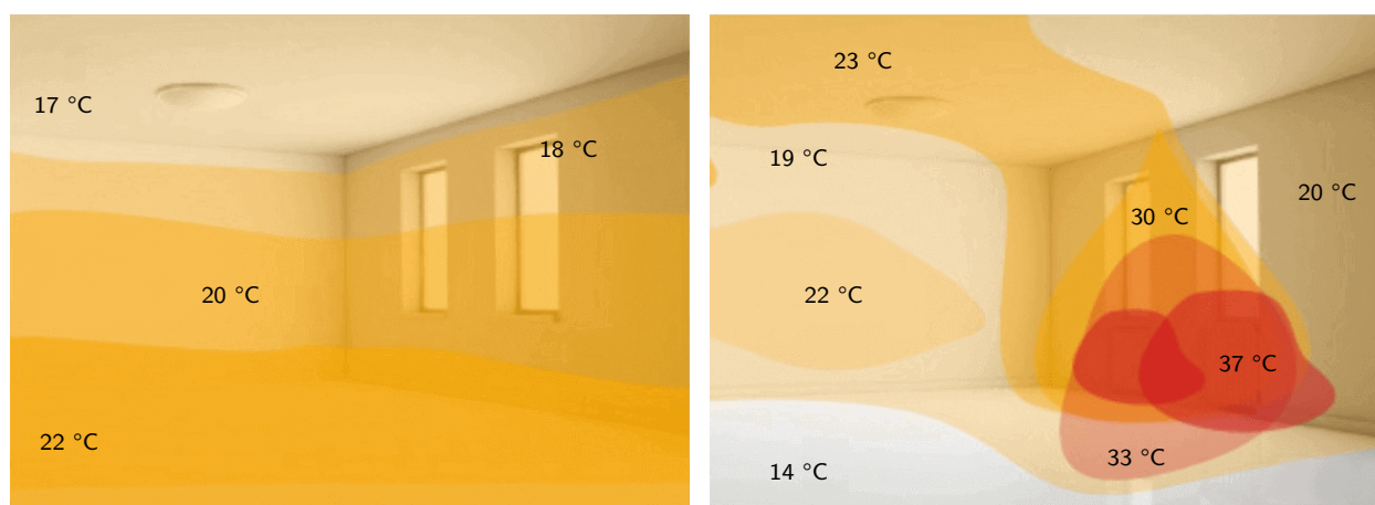
(a) : Rozložení teplot při použití podlahové vytápění.
