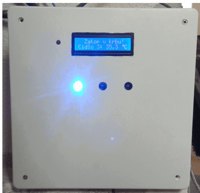
Obrázek 4.22: Víko instalační krabice. Osazený LCD displej, signalizačních LED (zleva modrá, oranžová a červená) a LED pro aktivování elektronické pojistky (červená LED vlevo od displeje).
